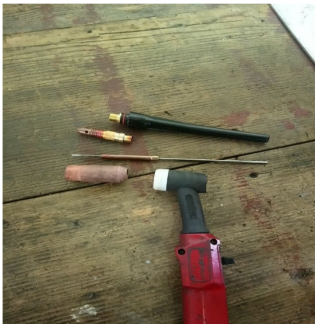
Slika 32. Dijelovi pištolja koji su se koristili u TIG navarivanju
