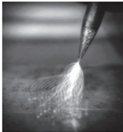
Slika 6. Uspostava električnog luka [8]
