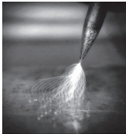
Slika 6. Uspostava električnog luka [8]
