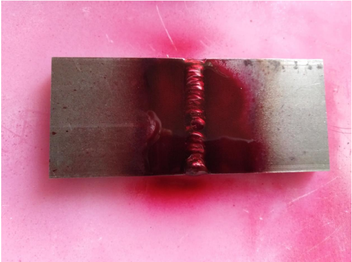
Slika 37 Nanošenje penetranta na površinu zavara ispitnog objekta 1
