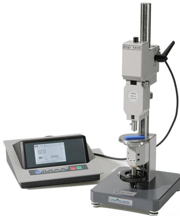
Slika 8 Ispitivanje tvrdoće po Shoreu [20]
