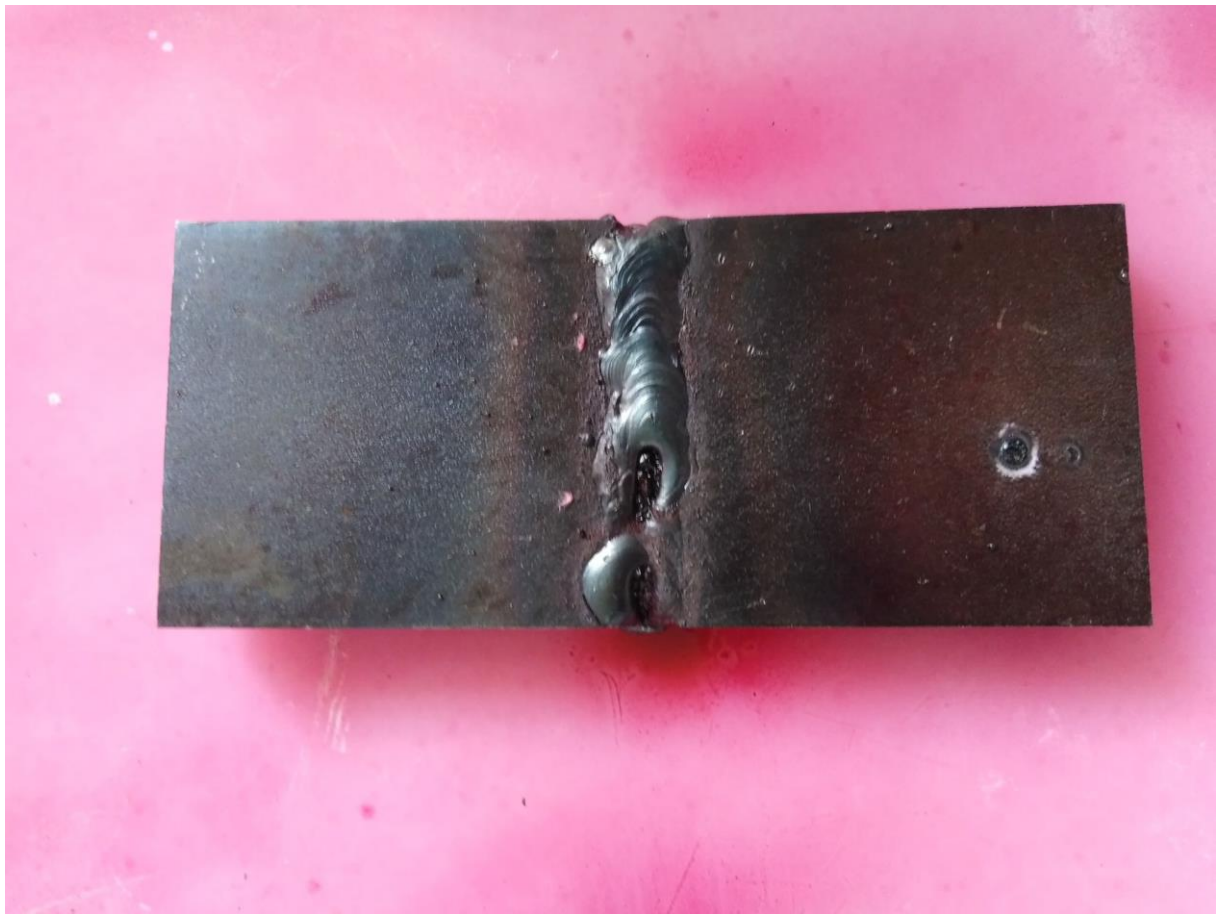
Slika 36 Očišćeni ispitni objekt 2 spreman za nanošenje penetranta
