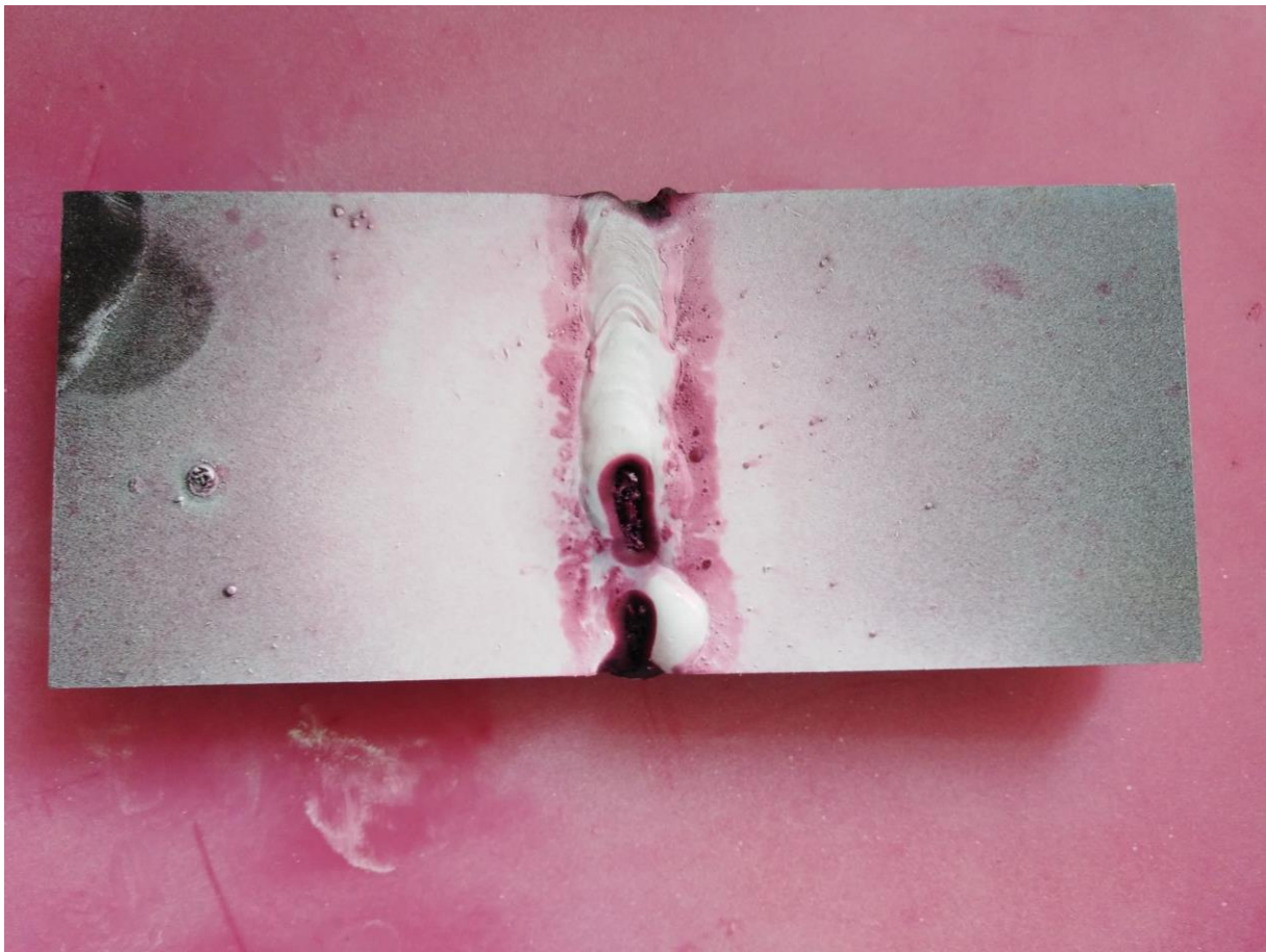
Slika 40 Ispitni objekt 2 razvijač osušen
