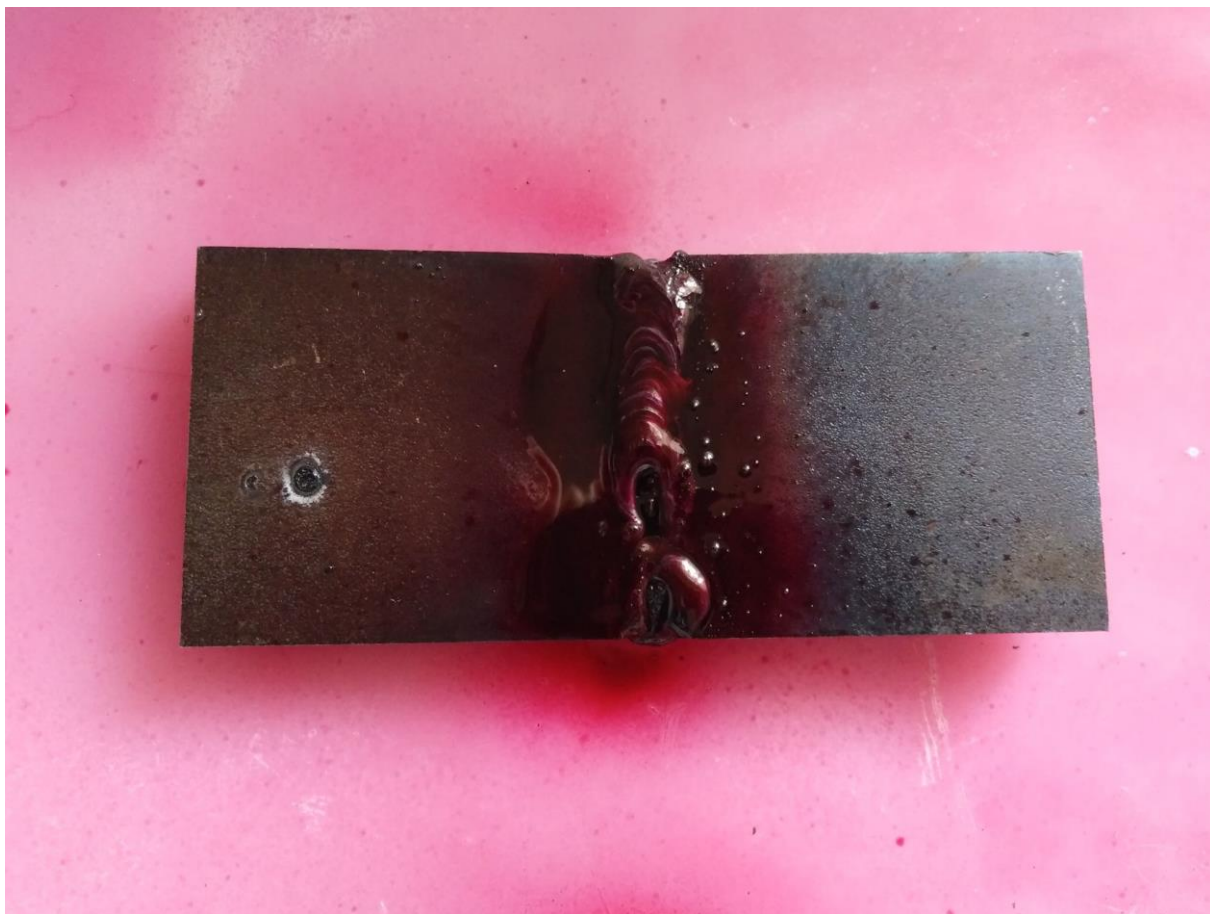
Slika 38 Nanošenje penetranta na površinu zavora ispitnog objekta 2
