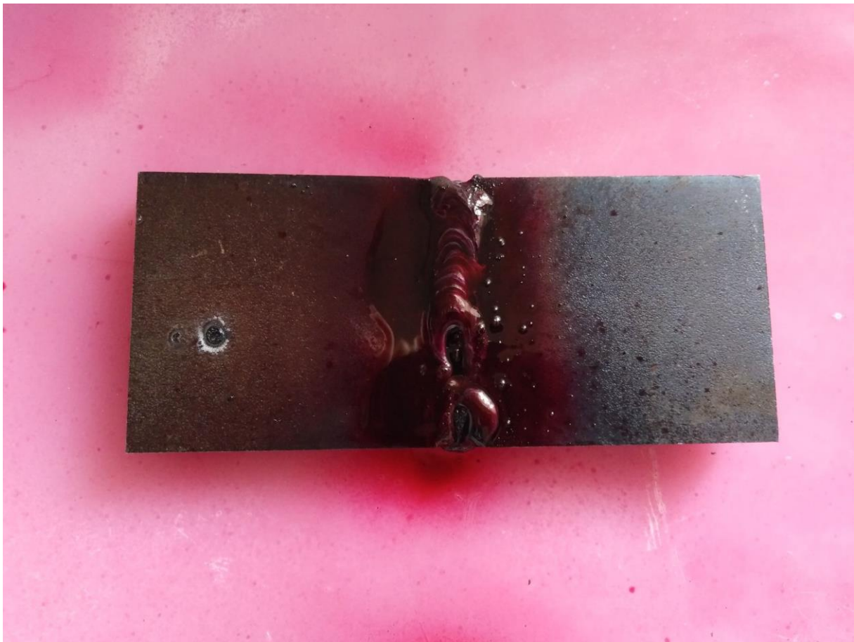
Slika 38 Nanošenje penetranta na površinu zavora ispitnog objekta 2
