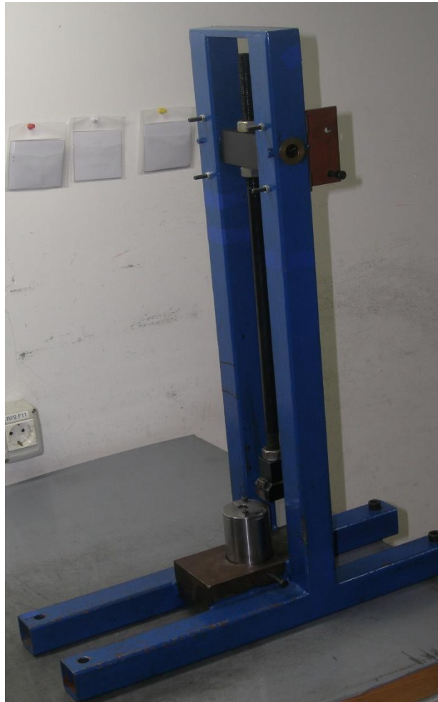
Slika 48: Bat i priprema za stezanje ispitnih uzoraka
