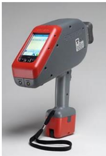
Slika 44: Uređaj za analizu kemijskog sastava materijala
