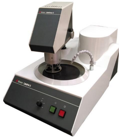
Slika 55: Uređaj za poliranje Struers LoboPol-5
