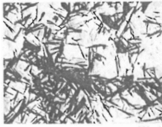
Slika 27: Čelik sa 0,98% C, 900°C/4min, 300°C/voda ; Austenitno-perlitna transformacija je napredovala [4]
