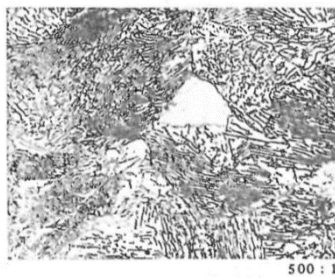
Slika 19: Čelik sa 0,98% C, 900°C/15min, 700°C/voda ; Završetak transformacije perlita [4]
