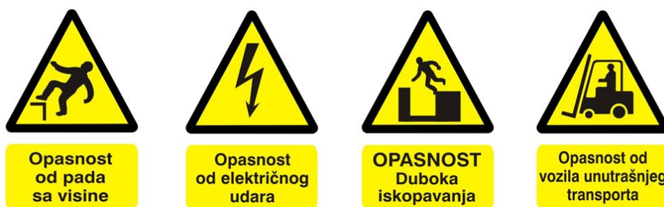
Slika 7. Znakovi opasnosti na gradilištu [16]
