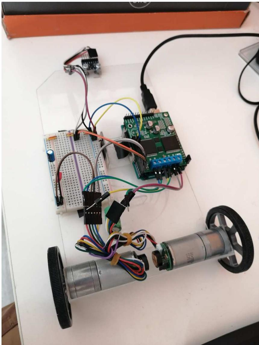
*Slika 13 - Testni robot s DC motorima*
