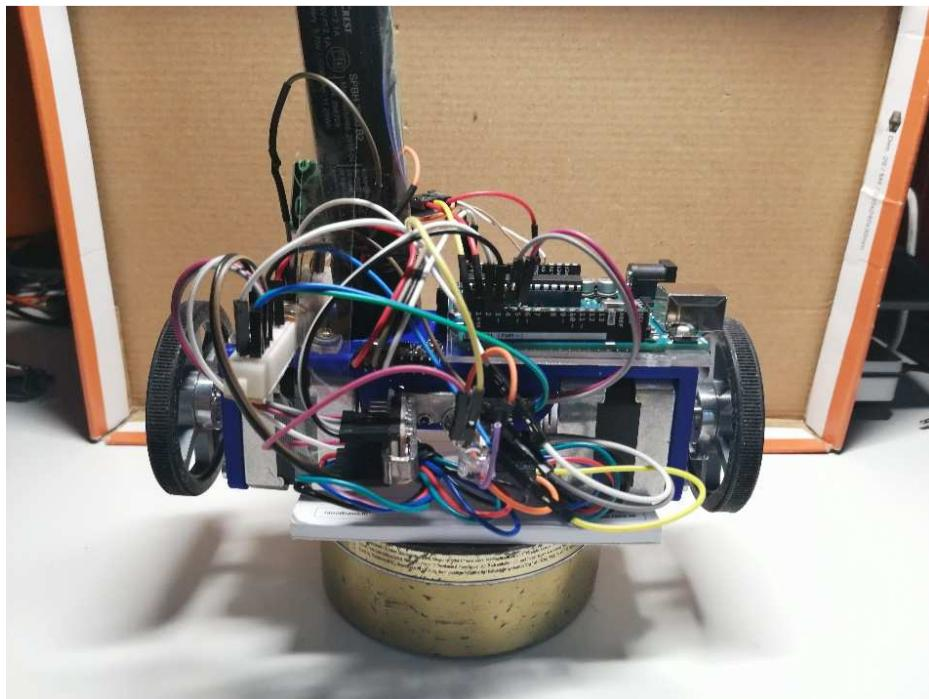
Slika 18 – Prva izvedba robota sa koračnim motorima
