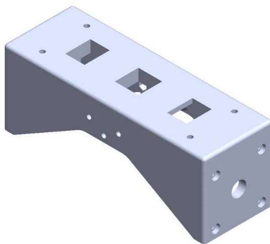
Slika 28 – CAD model šasije robota
