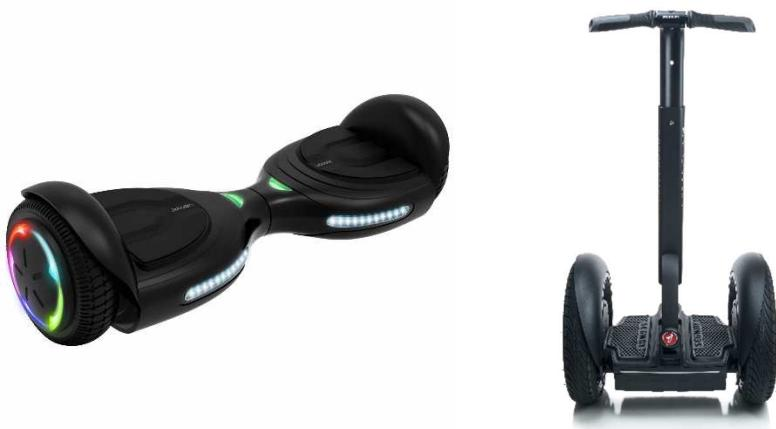
*Slika 1 - Komercijalne izvedbe sustava inverznog njihala*
