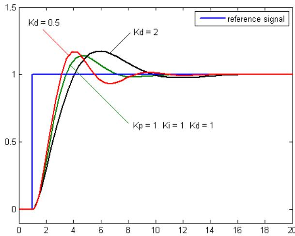
Slika 6 – Efekti promjene  $K_D$  parametara na odziv regulatora
