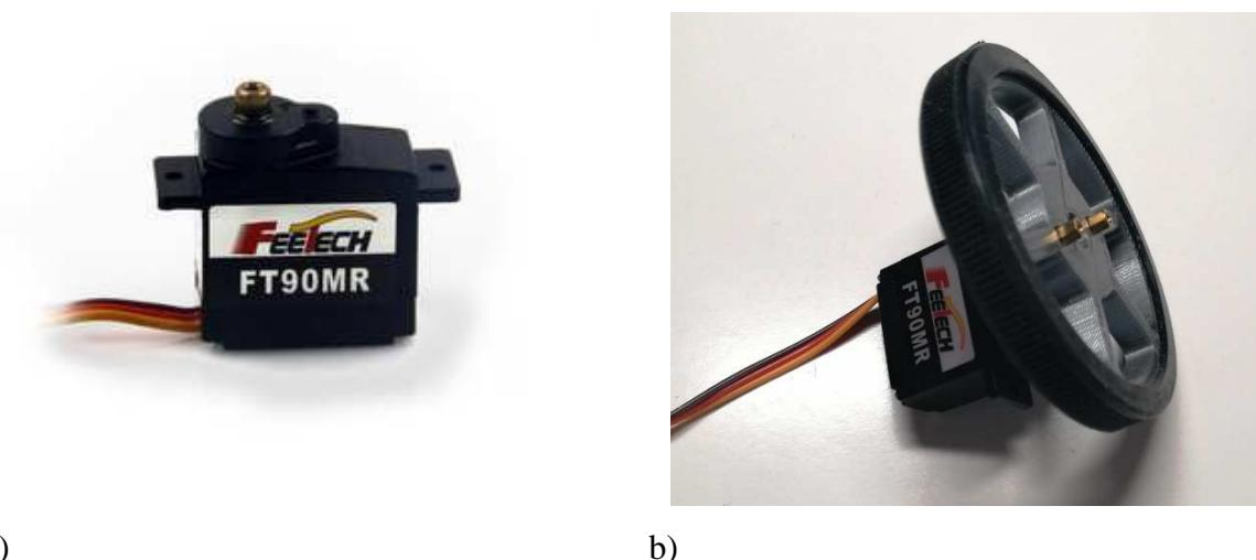
Slika 7 - FT90MR servo motor a), servo motor sa kotačem b)
