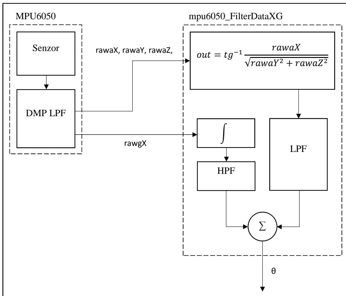
Slika 24 - Proces obrade signala inercijske jedinice
