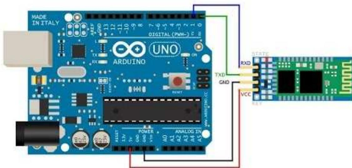
Slika 21 – Shema spajanja modula na Arduino
