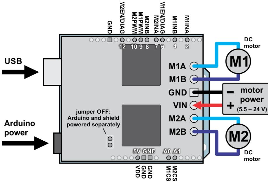
Slika 12 - Shema spajanja motora na VNH5019
