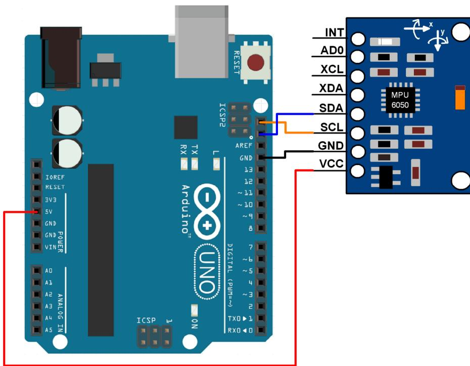
Slika 23 - Shema spajanja senzora na Arduino
