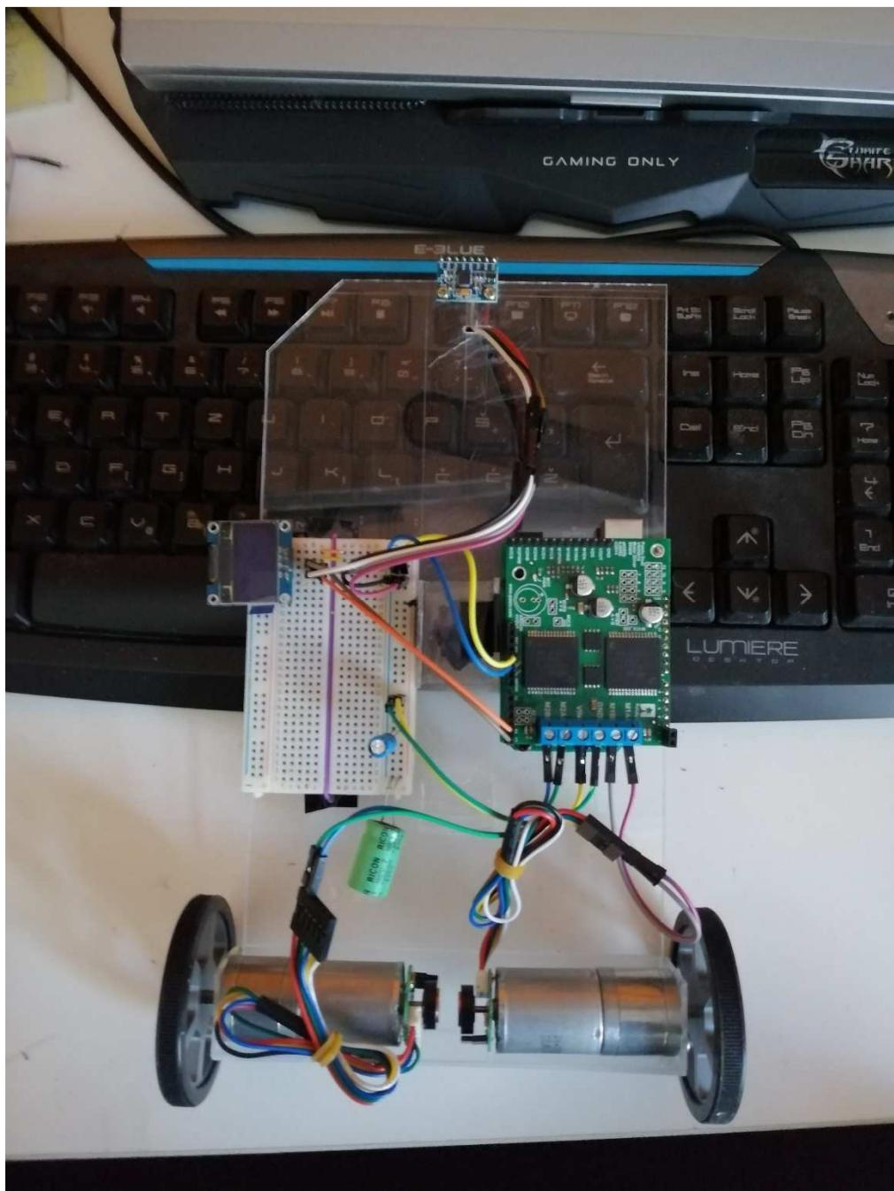
Slika 25 – Izvedba šasije robota sa DC motorima
