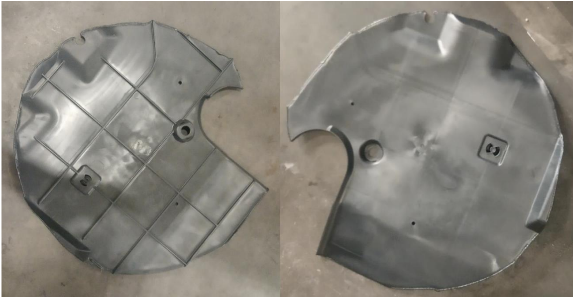
Slika 50. Dio proizvoda dobiven ubrizgavanjem sa sapnicom broj 3
