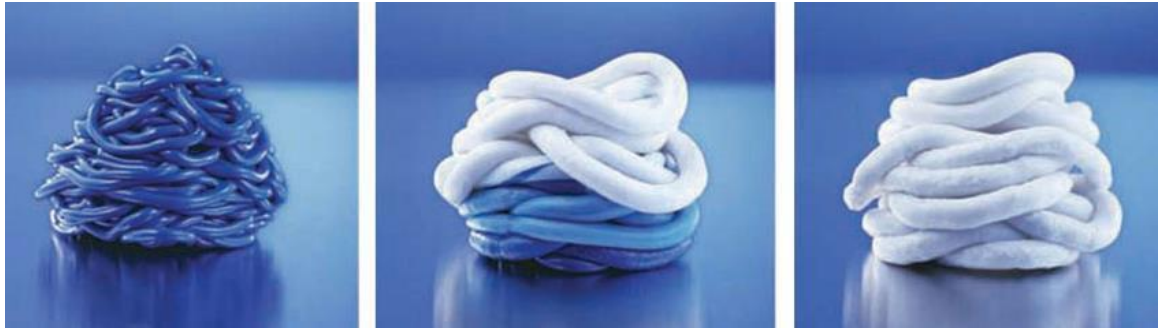
Slika 21. Utjecaj aditiva na promjenu boje u cilindru [7]
