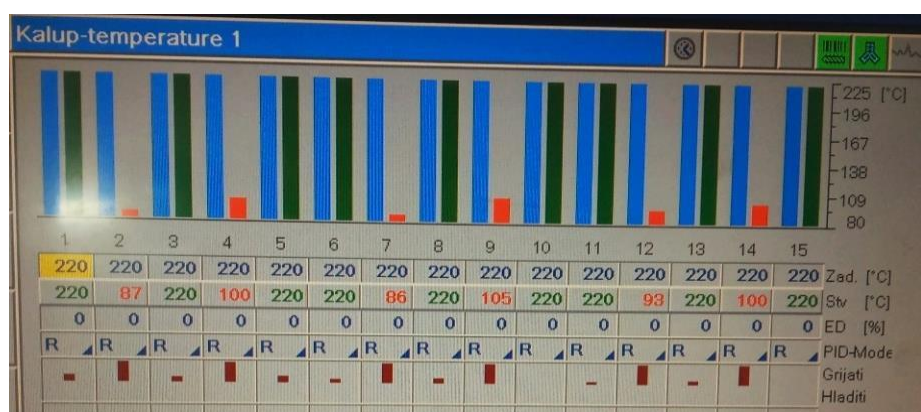
Slika 36. Temperature kalupa prilikom optimiranja
