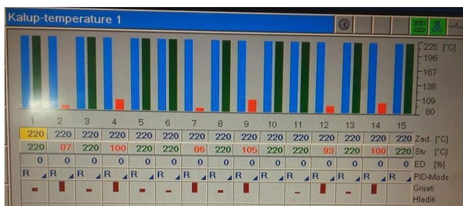
Slika 36. Temperature kalupa prilikom optimiranja
