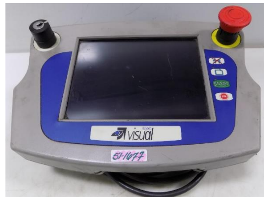
Slika 9. Kontroler za upravljanje sa Sepro robotom
