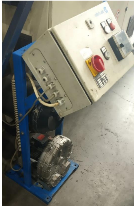
Slika 41. Pumpa za dovod materijala Colotronic
