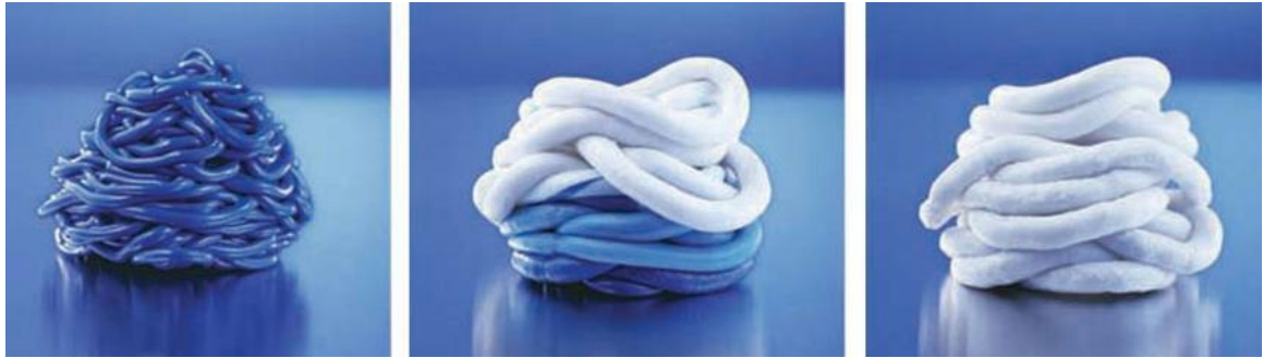
Slika 21. Utjecaj aditiva na promjenu boje u cilindru [7]
