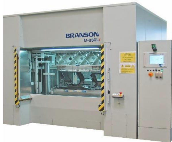
Slika 30. Uređaj za montažu (vibraciono zavarivanje) [12]
