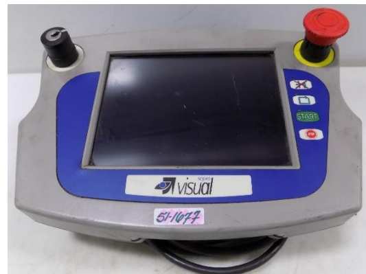
Slika 9. Kontroler za upravljanje sa Sepro robotom
