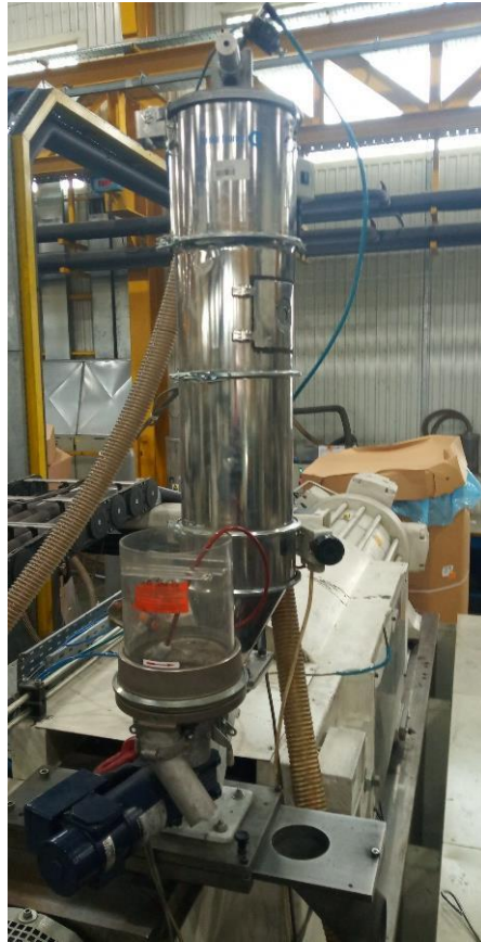
Slika 42. Dozator materijala Colotronic
