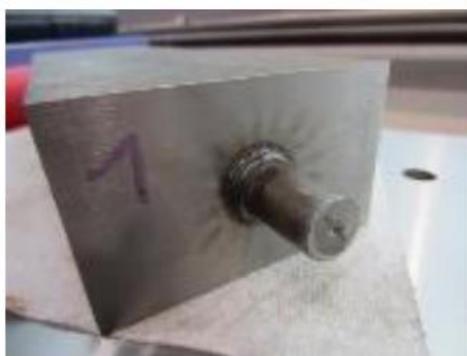
Slika 34 Obradak sa svornjakom zavarenim u okomitom položaju [18]
