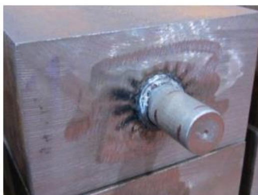
Slika 35 Obradak sa svornjakom zavarenim u vodoravnom položaju [18]
