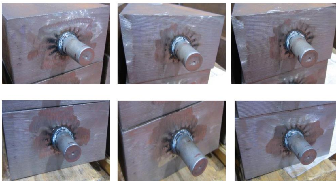
Slika 31 Prikaz uzoraka sa svornjacima zavarenim u vodoravnom položaju [18]
