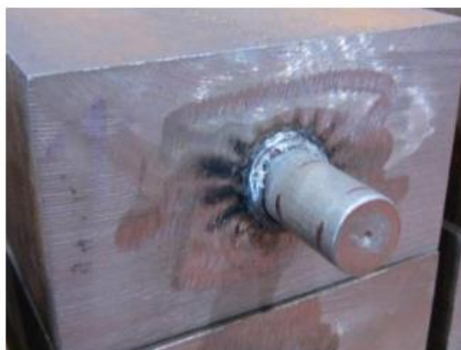
Slika 35 Obradak sa svornjakom zavarenim u vodoravnom položaju [18]
