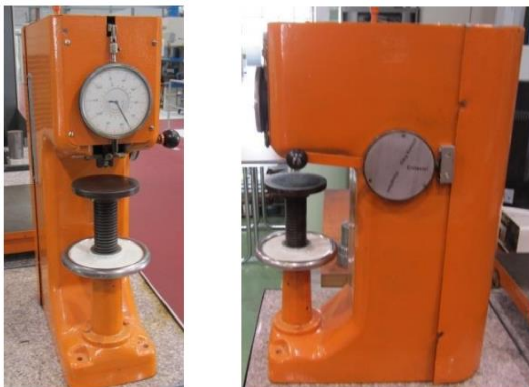
Slika 40 Stroj za ispitivanje tvrdoće HBW 2,5/187,5 [18]
