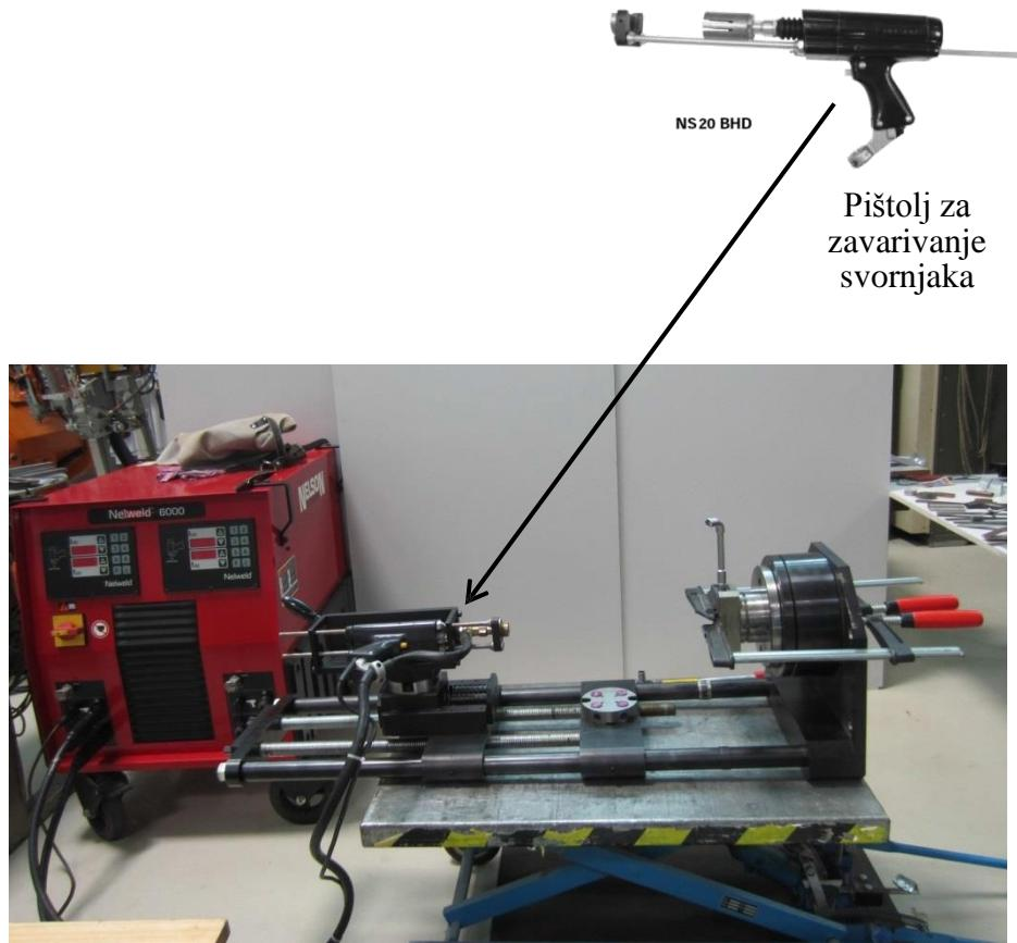
*Slika 22. Oprema korištena za provedbu eksperimentalnog dijela [18]*
