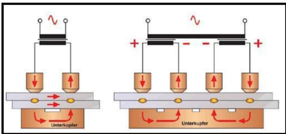
*Slika 2. Ilustracija indirektnog točkastog elektrootpornog zavarivanja [7]*
