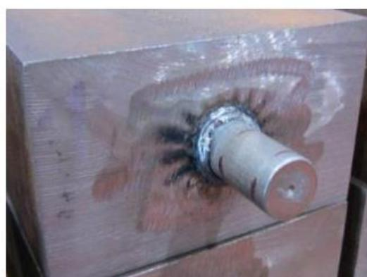
*Slika 35 Obradak sa svornjakom zavarenim u vodoravnom položaju [18]*
