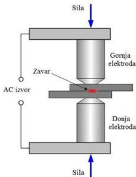
*Slika 1. Shematski prikaz direktnog točkastog elektrootpornog zavarivanja [6]*
