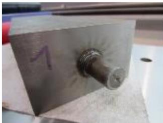
Slika 34 Obradak sa svornjakom zavarenim u okomitom položaju [18]
