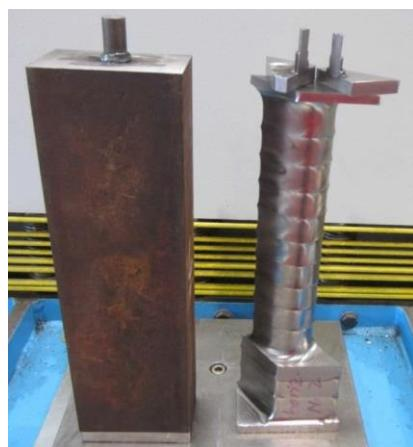
*Slika 23. Sirovi i obrađeni komad sa zavarenim svornjakom za prihvatanje u stroj [18]*
