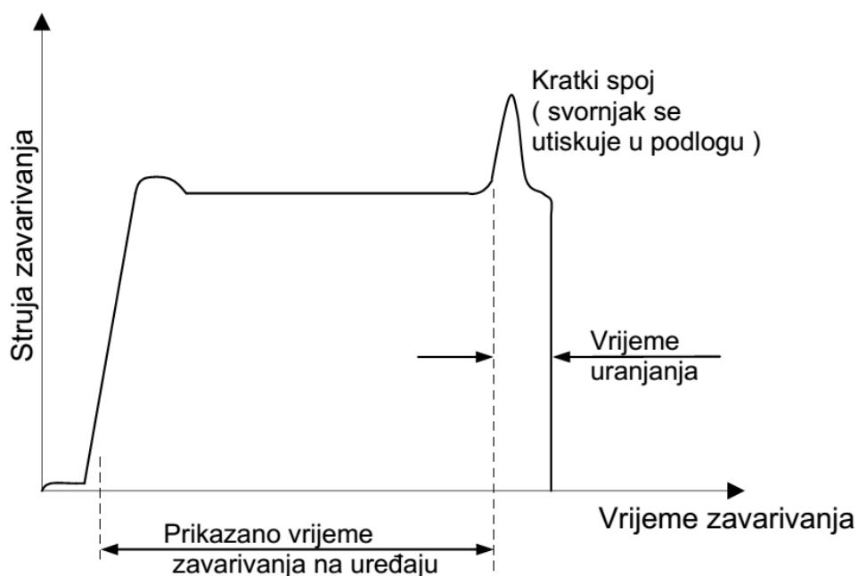
*Slika 19. Shematski prikaz ovisnosti struje i vremena zavarivanja [10]*
