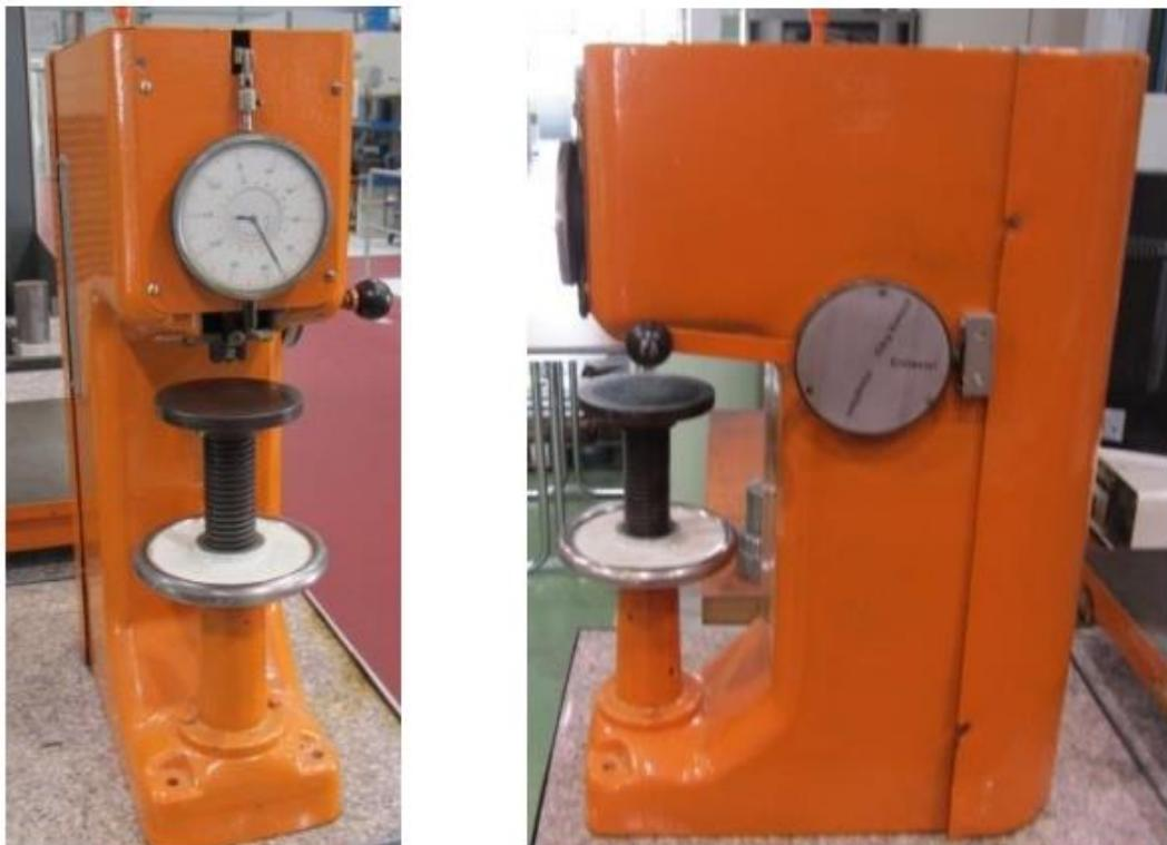
*Slika 40 Stroj za ispitivanje tvrdoće HBW 2,5/187,5 [18]*
