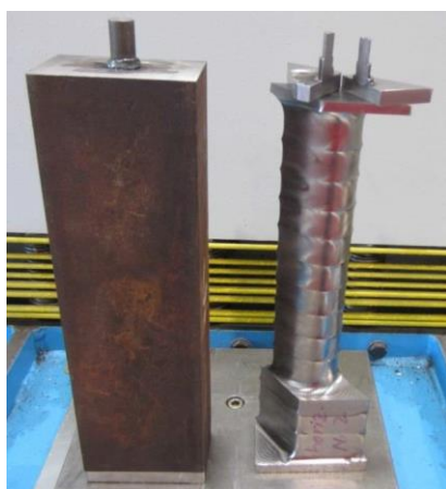
Slika 23. Sirovi i obrađeni komad sa zavarenim svornjakom za prihvata u stroj [18]
