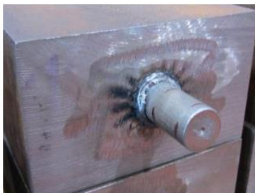
Slika 35 Obradak sa svornjakom zavarenim u vodoravnom položaju [18]
