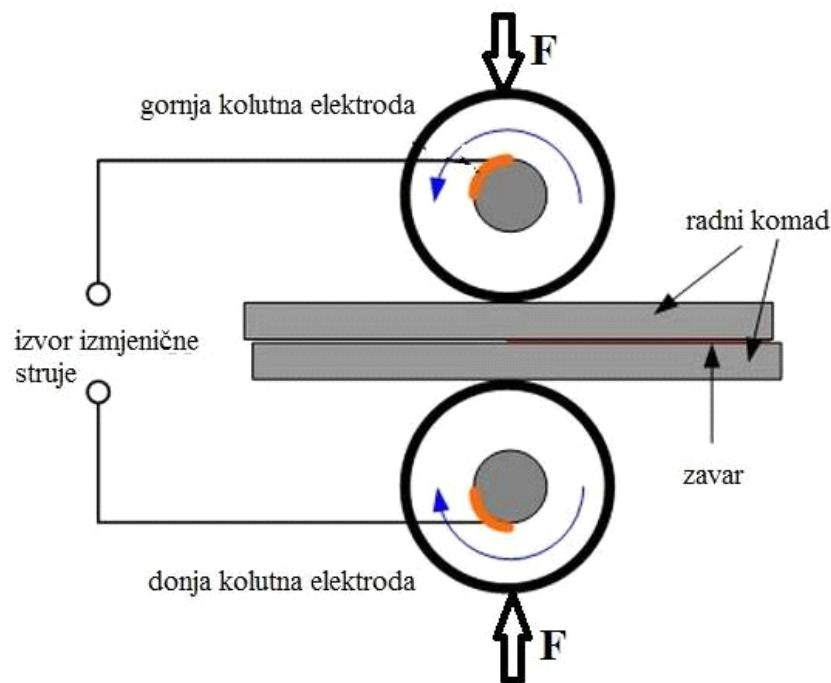
*Slika 4. Shema šavnog zavarivanja (dvostranog) [6]*
