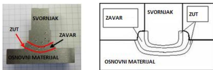
*Slika 41 Ispitani uzorak i shematski prikaz zona zavara [18]*
