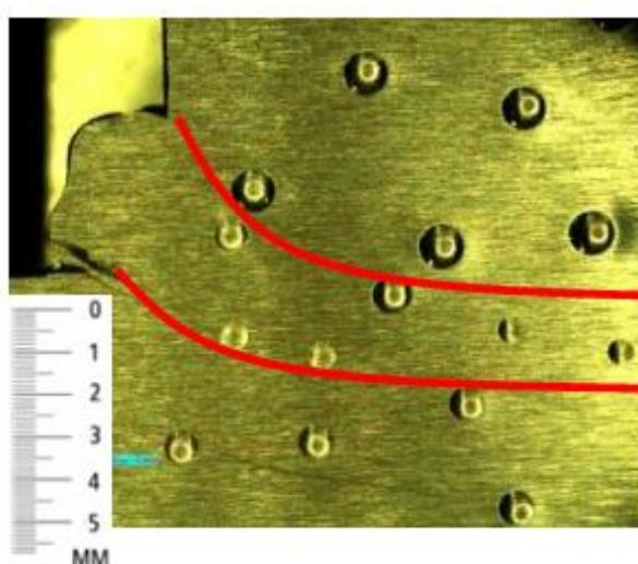
*Slika 42 Mjerenje tvrdoće na obratku sa svornjakom zavarenim u okomitom položaju [18]*
