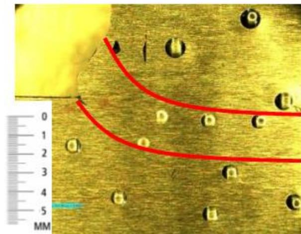
*Slika 30 Ispitivanje tvrdoće u zonama zavarenog spoja [18]*
