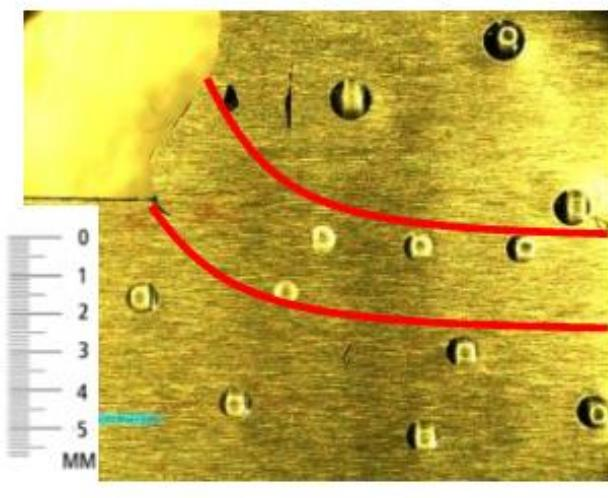
Slika 43 Mjerenje tvrdoće na obratku sa svornjakom zavarenim u vodoravnom položaju [18]
