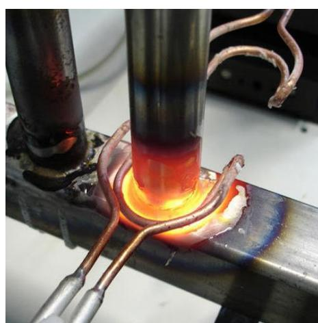
*Slika 10. Indukcijsko zavarivanje [13]*
