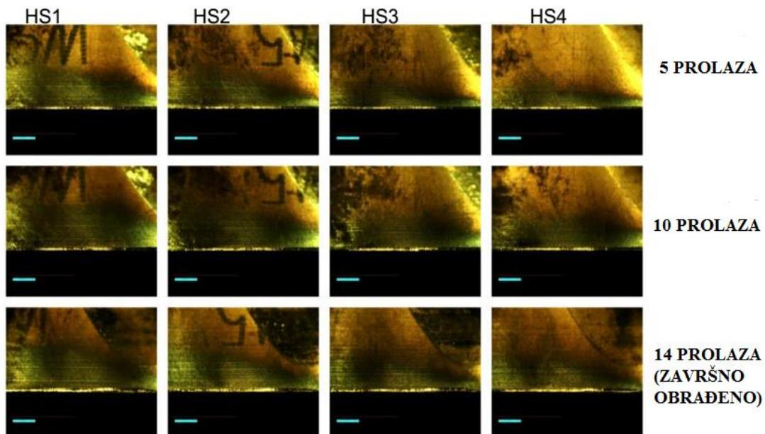
*Slika 38 Trošenje oštice alata ovisno o broju prolaza na obratcima sa pinom zavarenim u okomitom položaju [18]*
