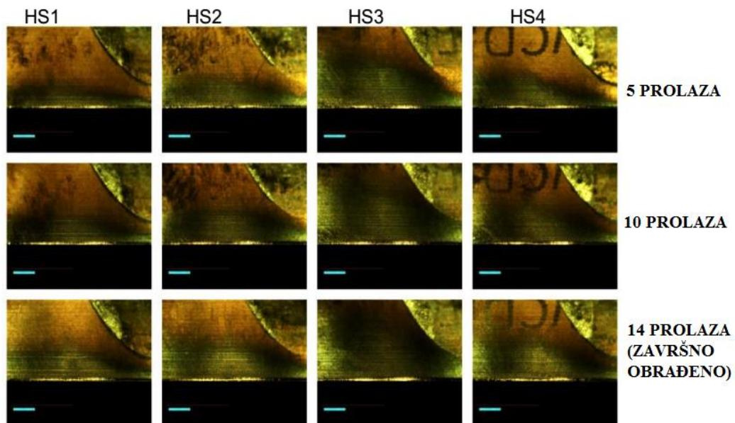
Slika 39 Trošenje oštice alata ovisno o broju prolaza na obratcima sa pinom zavarenim u vodoravnom položaju [18]
