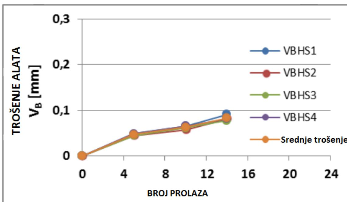
Tablica 11. Trošenje oštice na obradku sa svornjakom zavarenim u vodoravnom položaju [18]
