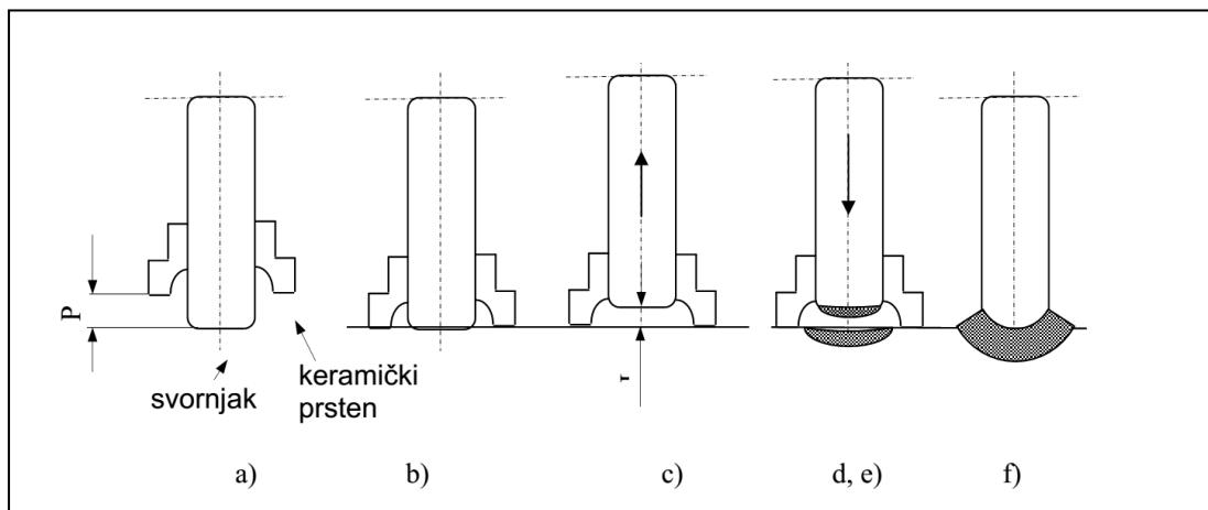
*Slika 18. Faze radnih koraka kod zavarivanja svornjaka poluautomatskim postupkom zavarivanja [10]*
