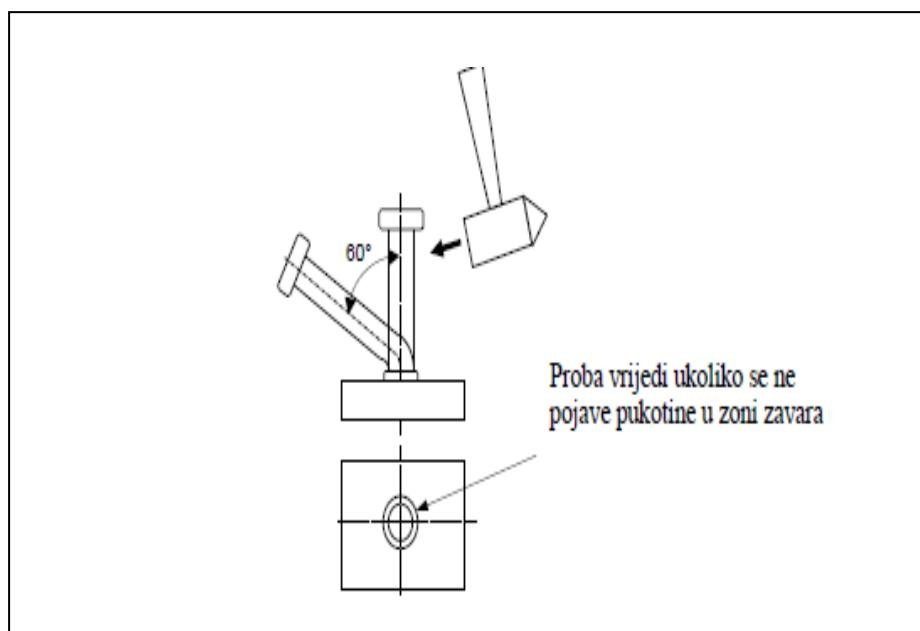
Slika 21. Proba savijanja u svrhu ispitivanja kvalitete zavara svornjaka [10]
