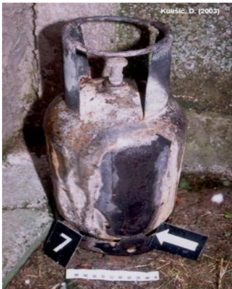
Slika 19. Izgled plinske boce nakon eksplozije plina.[29]
