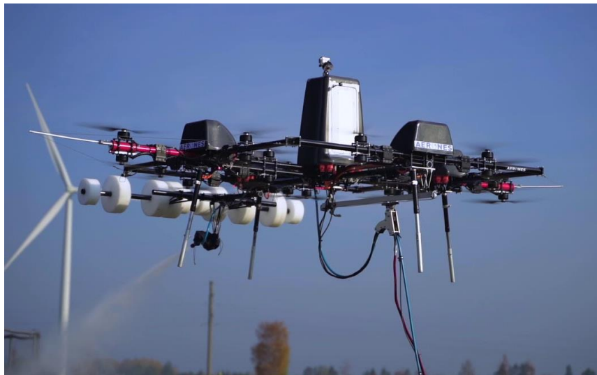
Slika 5. Dron s mlaznicom tvrtke Aeronex.[6]
