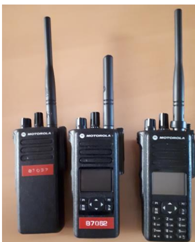
Slika 18. Ručne radiostanice Motorola DP 4401, DP4601 i DP4801, fotografija D.Kos
