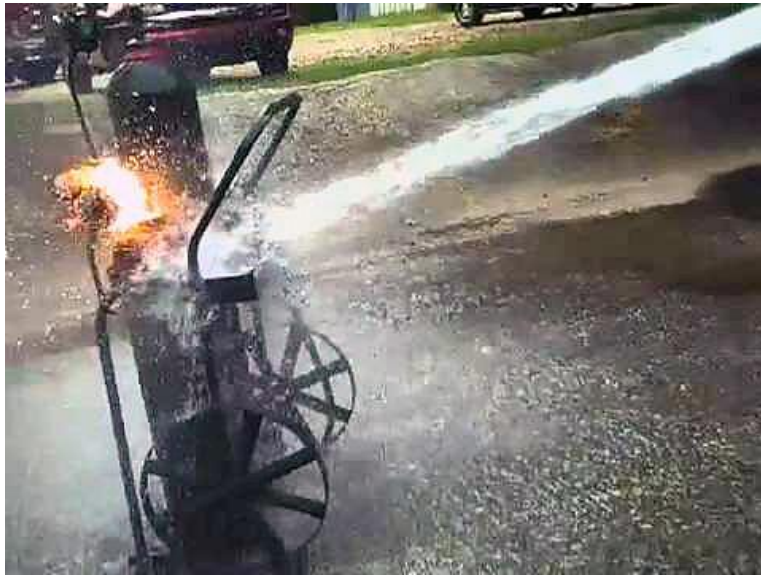
Slika 26. Zapaljenje boce s acetilenom i zalijevanje vodom
