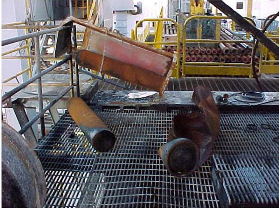
Slika 24. Izgled boce acetilena nakon eksplozije
