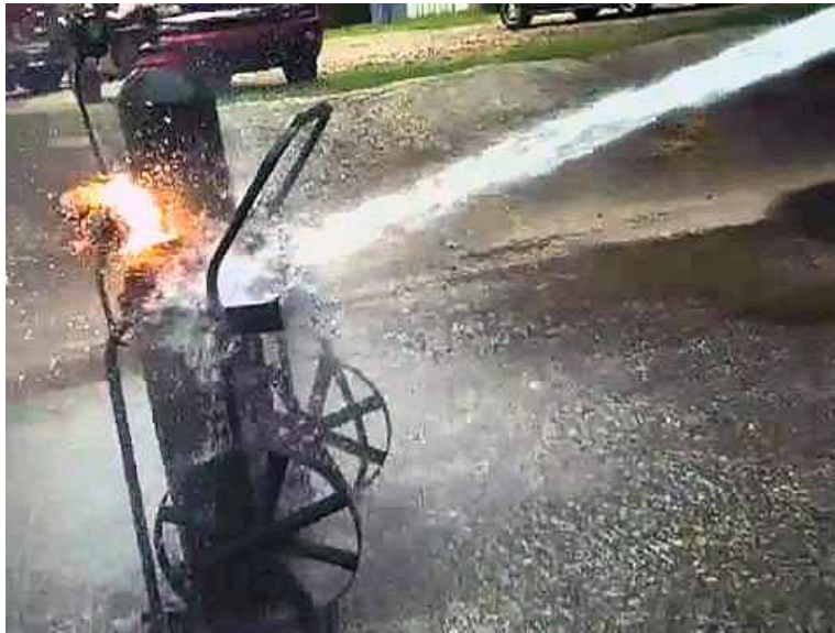
Slika 26. Zapaljenje boce s acetilenom i zalijevanje vodom
