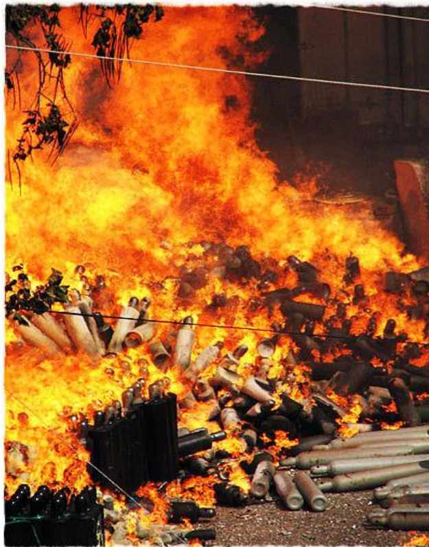
Slika 27. Zapaljenje acetilenske stanice s bocama acetilena
