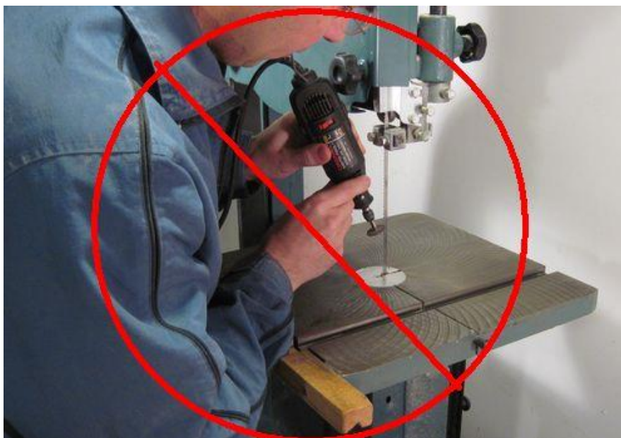
Slika 9. Nepravilno oštrenje zupca tračne pile [9]
