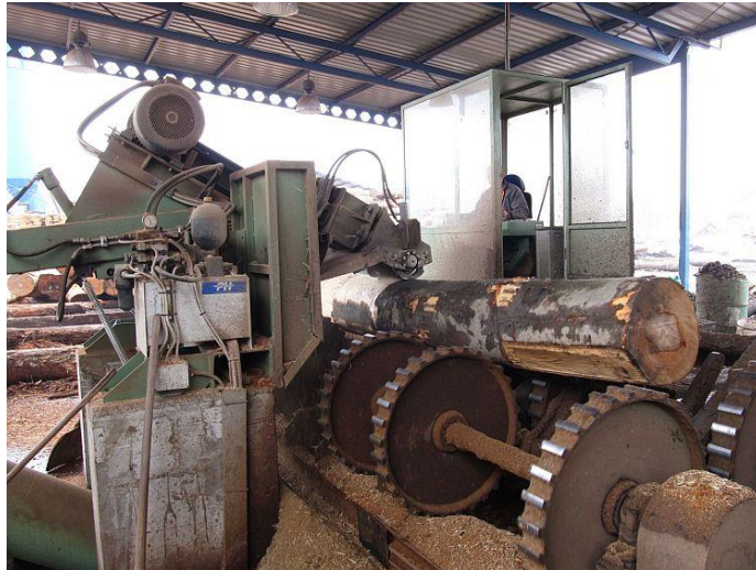
Slika 21. Skidanje kore trupaca „Drvni centar Glina“ [21]
