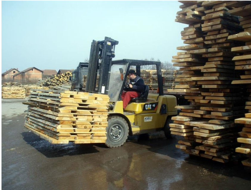
Slika 23. Ispravan prijevoz tereta viličarem „Drvni centar Glina“ [23]
