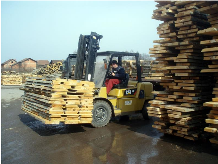
Slika 23. Ispravan prijevoz tereta viličarem „Drvni centar Glina“ [23]
