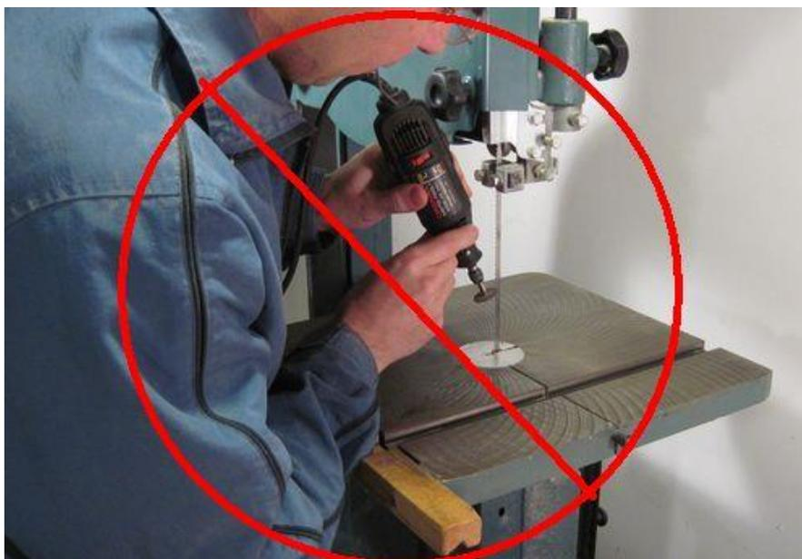
Slika 9. Nepravilno oštrenje zupca tračne pile [9]
