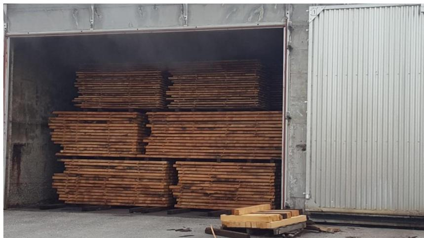
Slika 26. Sušara drvene piljene građe [26]
