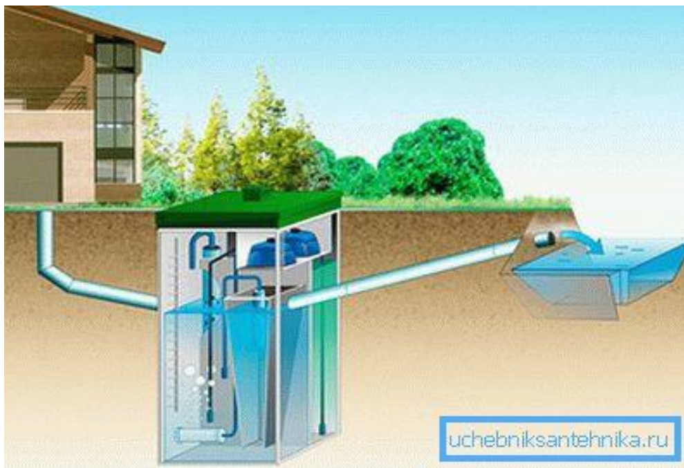
Slika 15. Septonski spremnik za visoke razine podzemnih voda
