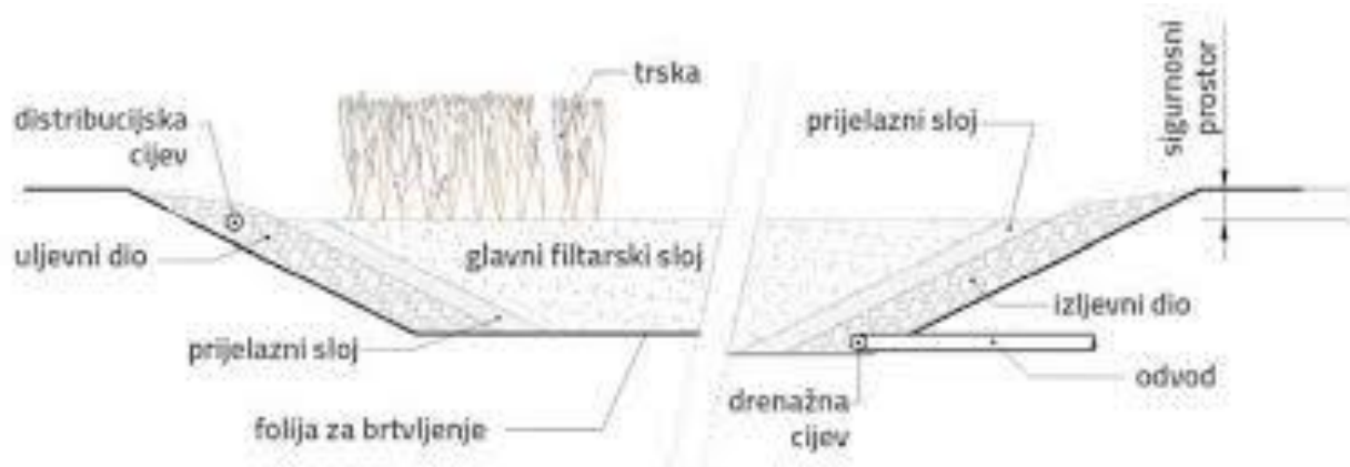
Slika 18. Biljni uređaj sa slobodnim vodenim licem
