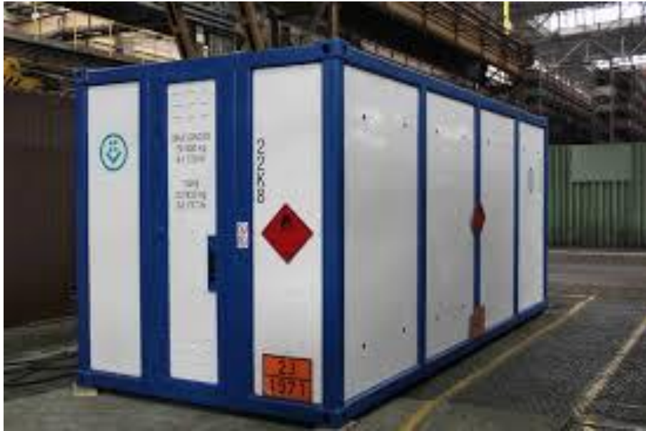
Slika 18. MEGC (Multiple element gas container) kontejner
