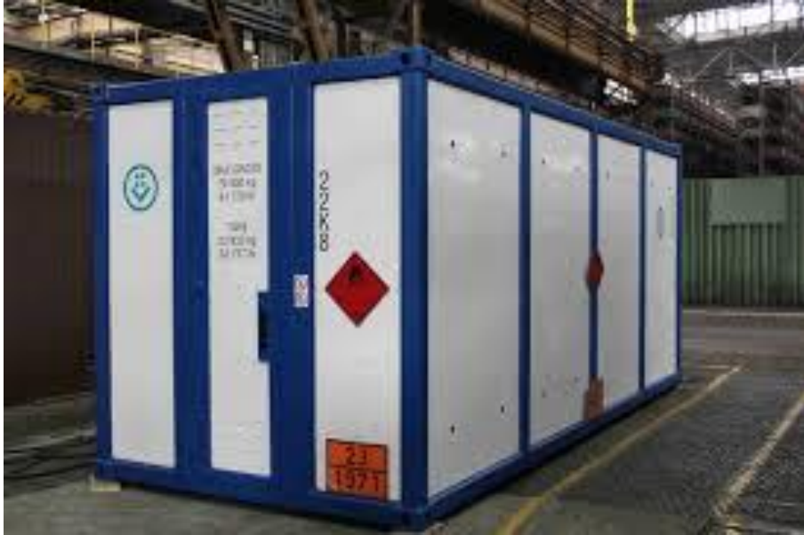
Slika 18. MEGC (Multiple element gas container) kontejner
