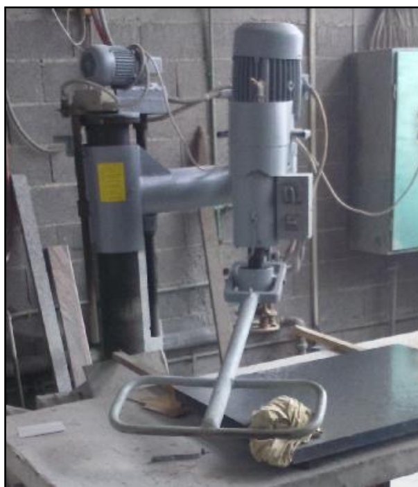
Slika 11. Stroj za brušenje kamena
