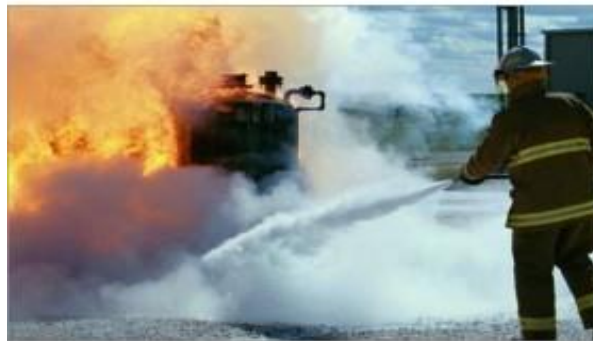
Sl. 2. Gašenje požara suhim prahom [4]
