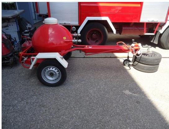
Sl. 30. Prijevodni aparat za gašenje prahom 250kg
