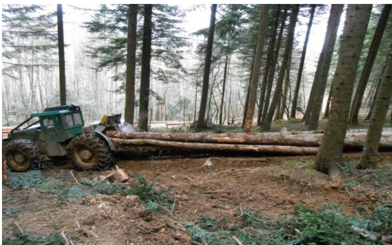
Slika 9. Privlačenje drvnih sortimenata
