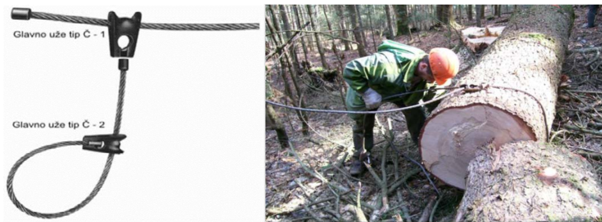
Slika 10. Prikaz glavnog vučnog užeta i čelične omče
