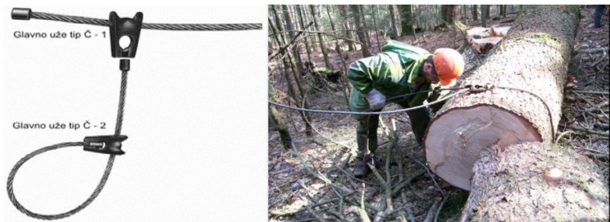
Slika 10. Prikaz glavnog vučnog užeta i čelične omče
