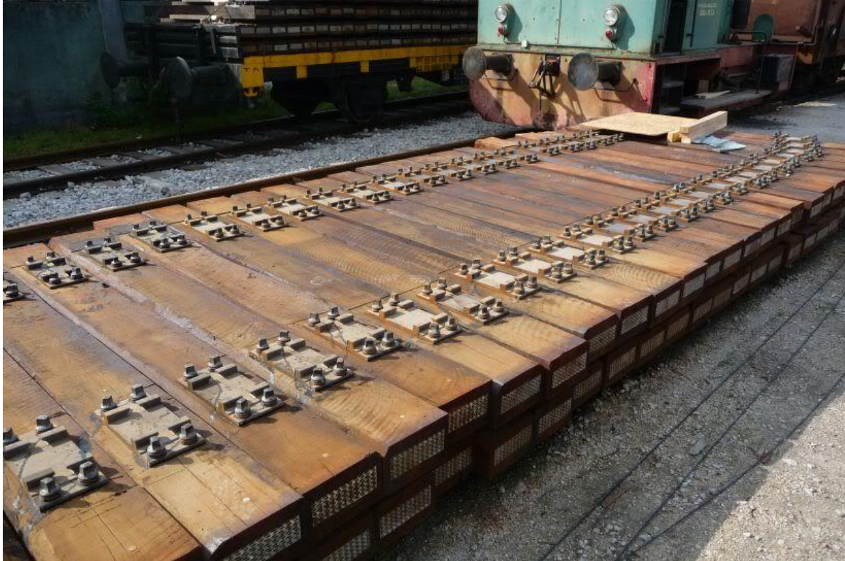
Sl.22. Montirani drveni željeznički prag
