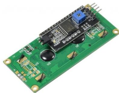
Slika 13. Predodžba adaptera za LCD 16x2.
