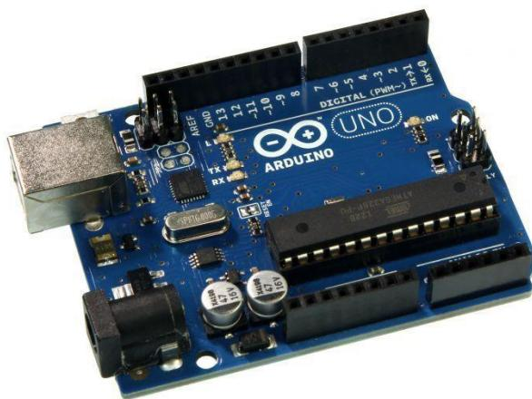
Slika 1. Predodžba Arduino pločice.
