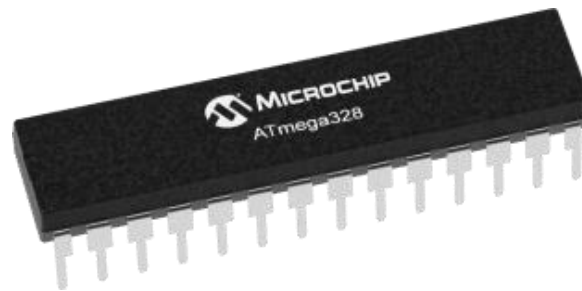
Slika 3. Predodžba mikrokontrolera ATMEGA328 korištenog na Arduinu.
