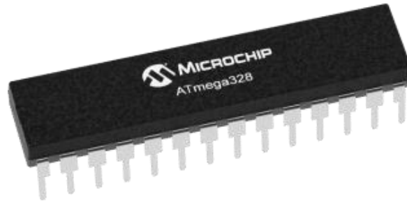
Slika 3. Predodžba mikrokontrolera ATMEGA328 korištenog na Arduinu.
