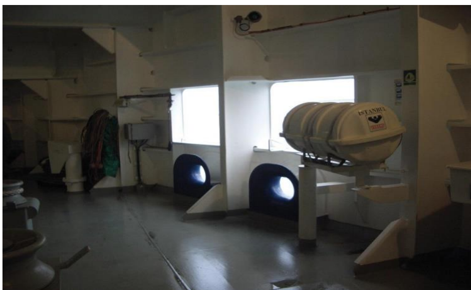
Slika 20. Splav za spašavanje na pramcu [17]
