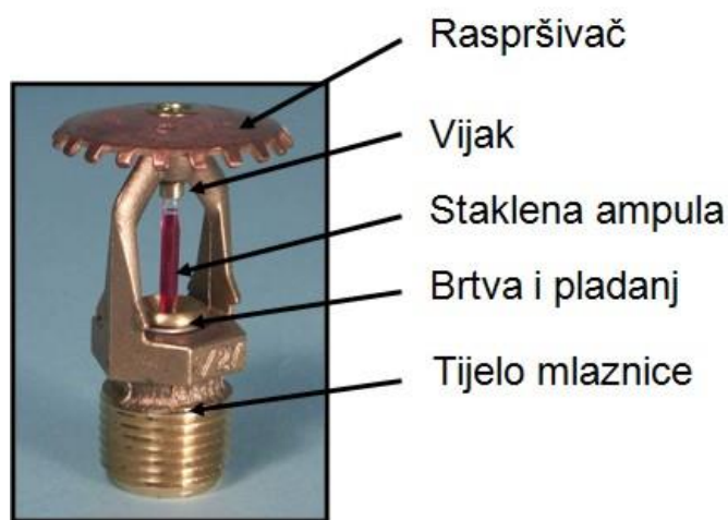
Slika 12. Sprinkler mlaznica
