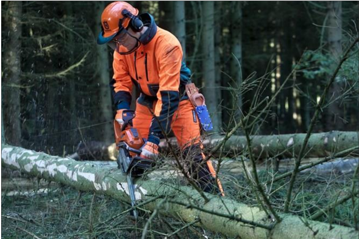
Slika 17. Piljenje grana s donje strane (izvor: http://www.husqvarna.com/ 2014.)
