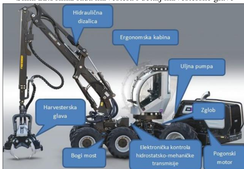
Slika 23. Dijelovi harvesterera Dijelovi harvesterera
