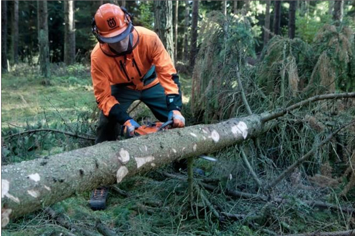
Slika 18. Otkres grana cijelog debla (izvor: http://www.husqvarna.com/ 2014.)
