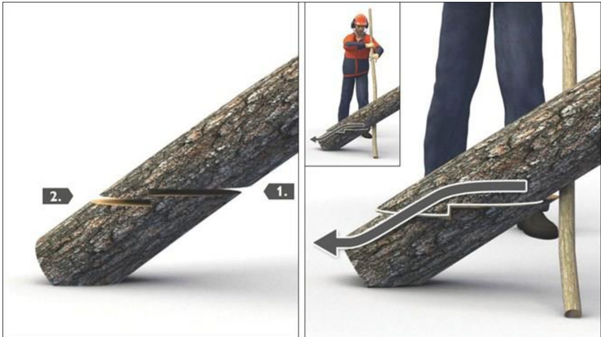
Slika 11. Stepenasta metoda (izvor: http://www.husqvarna.com/ 2014.)
