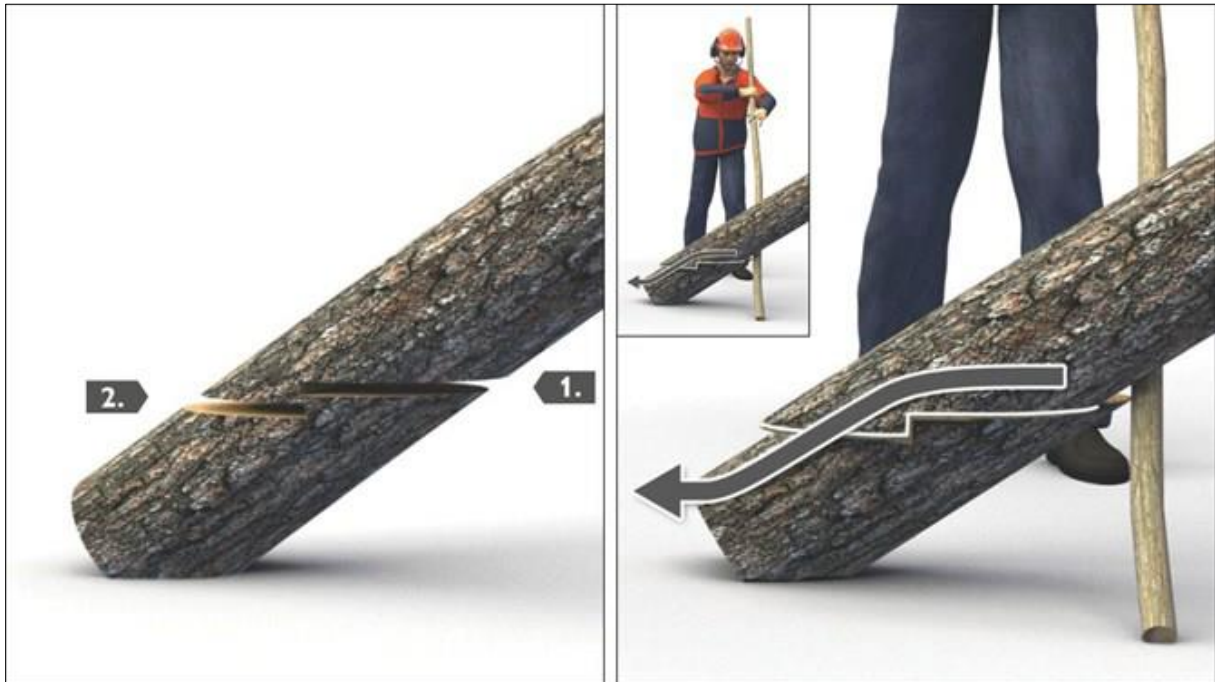
Slika 11. Stepenasta metoda (izvor: http://www.husqvarna.com/ 2014.)
