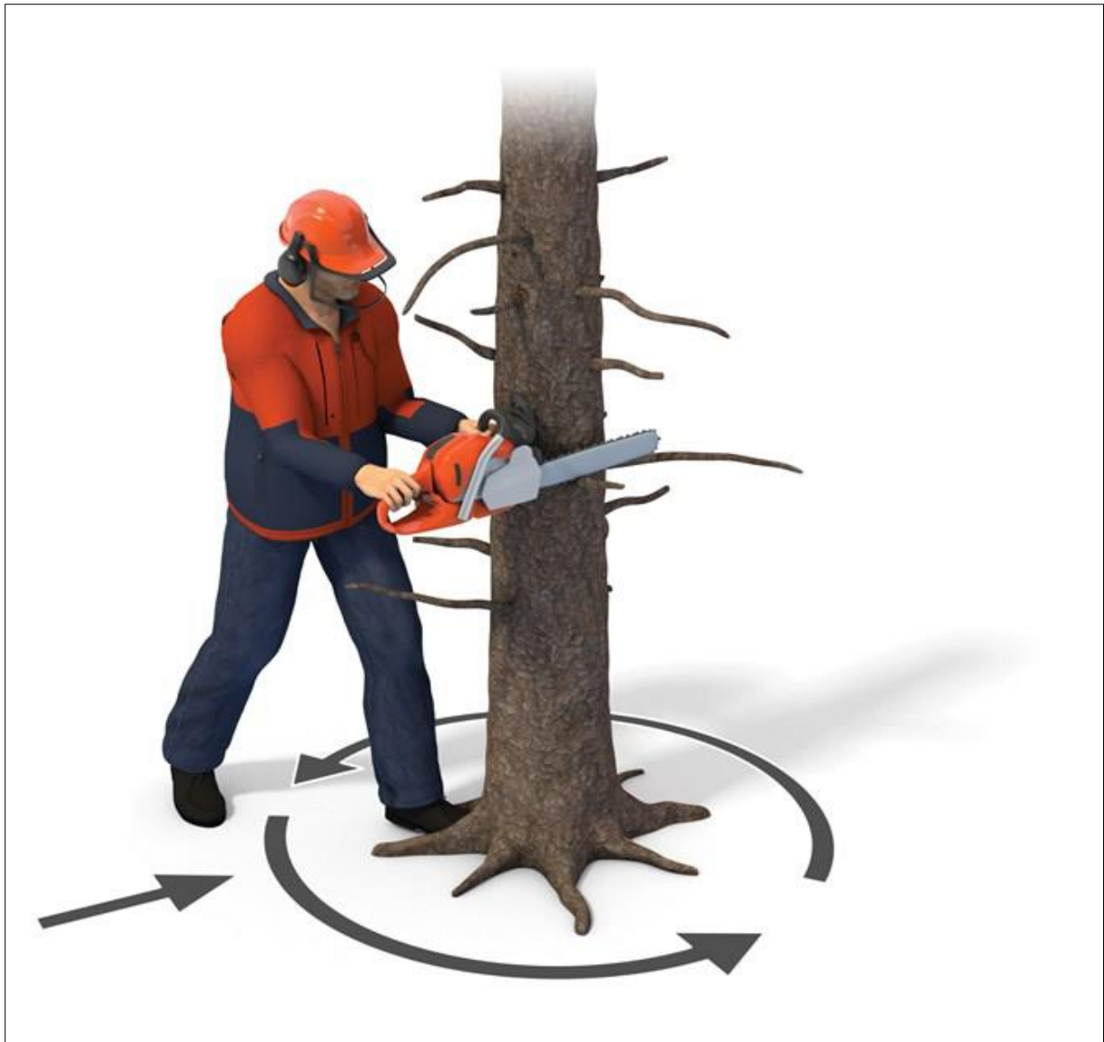
Slika 4. Uklanjanje grana i grančica (izvor: http://www.husqvarna.com/ 2014.)
