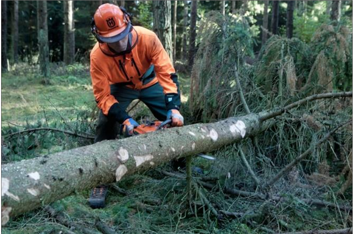
Slika 18. Otkres grana cijelog debla (izvor: http://www.husqvarna.com/ 2014.)
