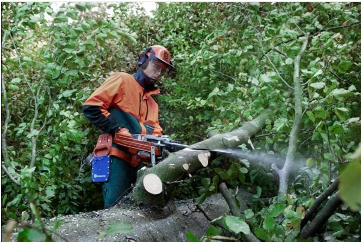
Slika 16. Piljenje grana (izvor: http://www.husqvarna.com/ 2014.)
