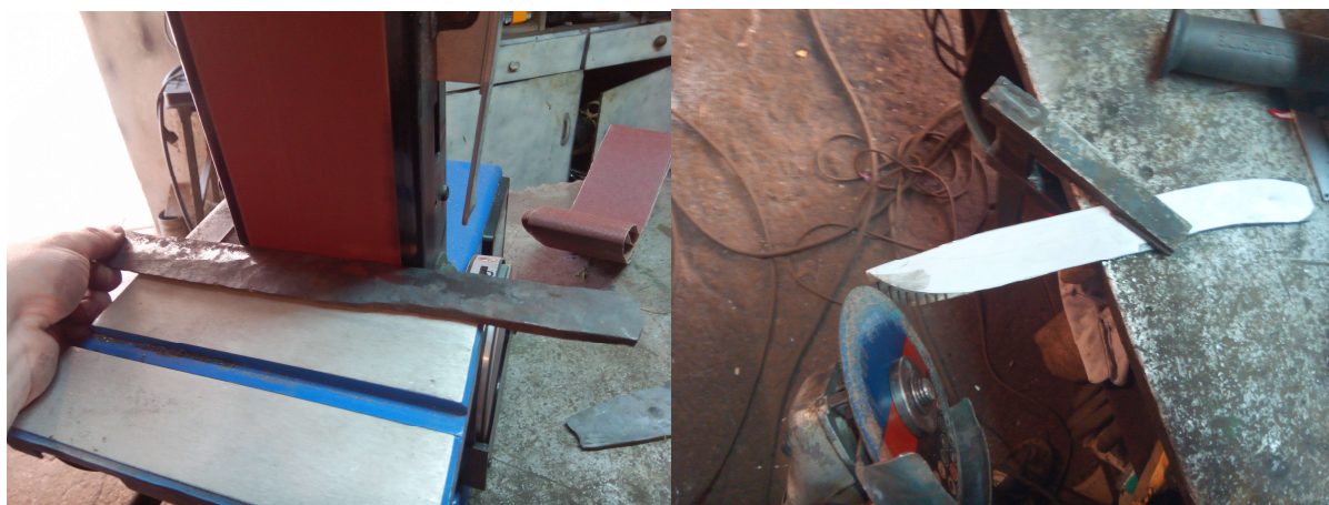
Slika 58 Prikaz brušenja i izrezivanja oblika
