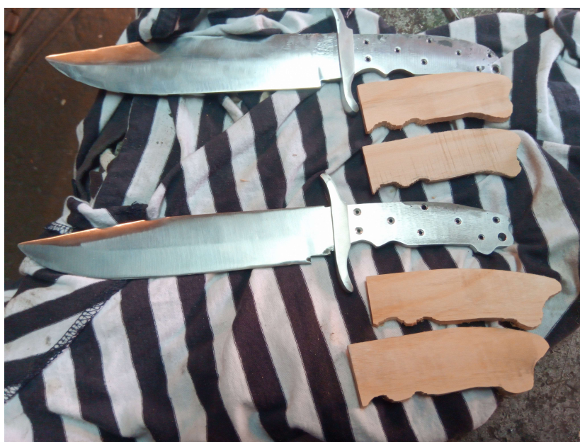
Slika 62 Noževi sa grubo izrezanim koricama i štitnikom za ruke
