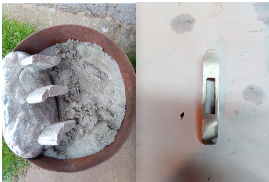
Slika 64 Odljevak i finalni oblik nakon brušenja
