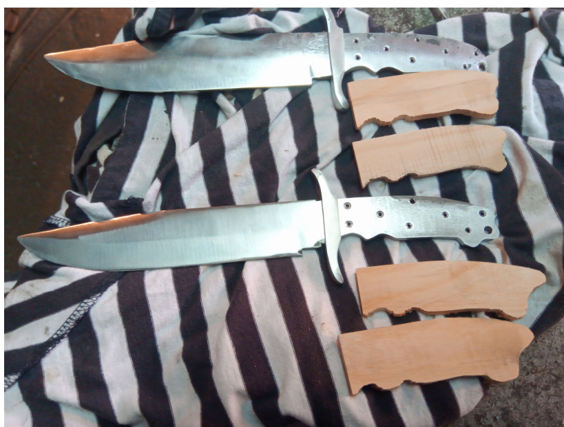
Slika 62 Noževi sa grubo izrezanim koricama i štitnikom za ruke
