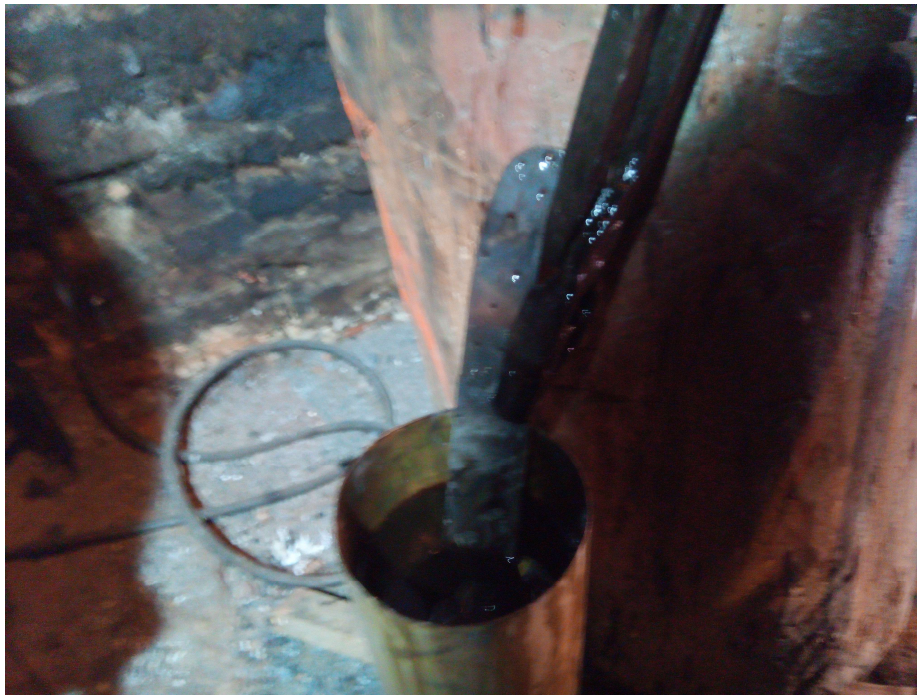
Slika 59 Kaljenje u ulju
