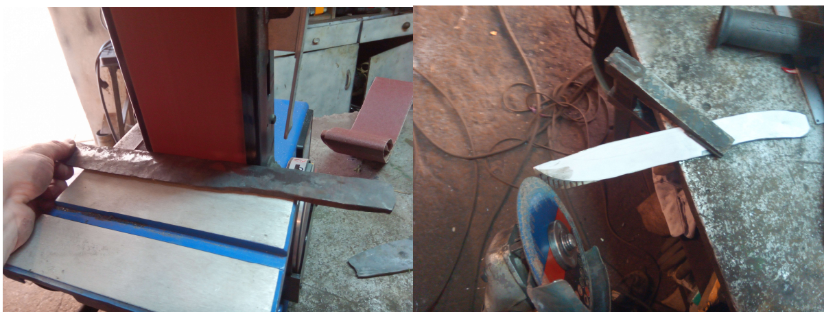
Slika 58 Prikaz brušenja i izrezivanja oblika
