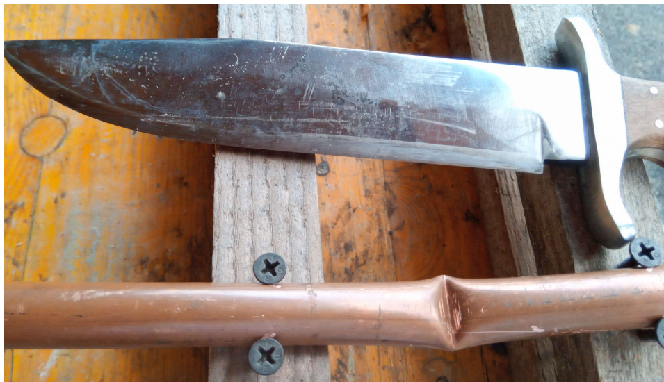
Slika 75 Oštećenja na bakrenoj cijevi i oštrica bez oštećenja (PER 1)
