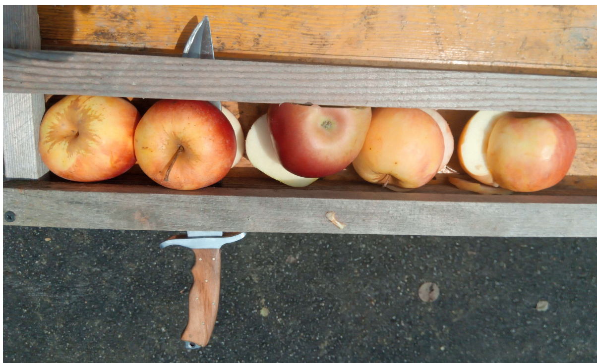
Slika 71 Drugi nož (PER 1) u drugom pokušaju, razrezane tri i četvrta jabuka zasječena
