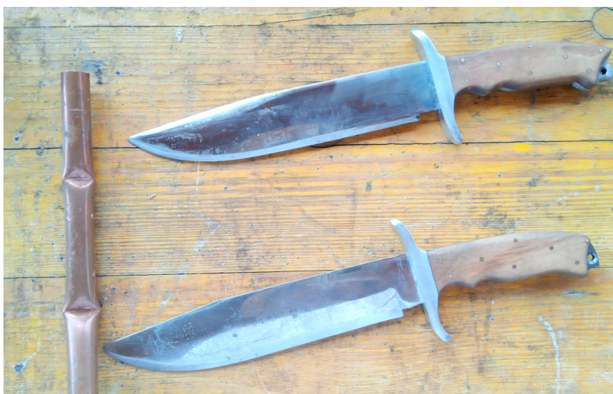
Slika 76 Prikaz oba noža i bakrene cijevi sa oštećenjima (gore osikro 4, dolje PER 1)
