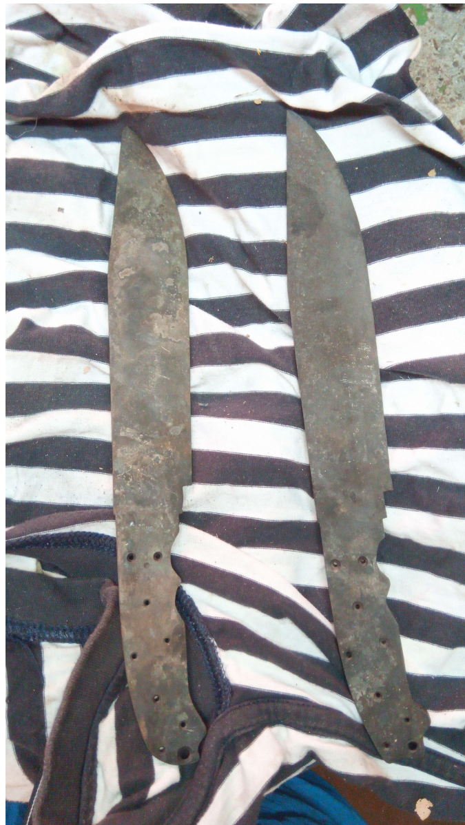
Slika 60 Noževi poslije kaljenja i popuštanja
