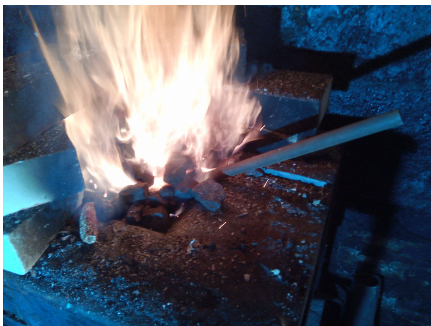
Slika 55 Ugrijavanje šipkastog materijala na kovačkoj vatri
