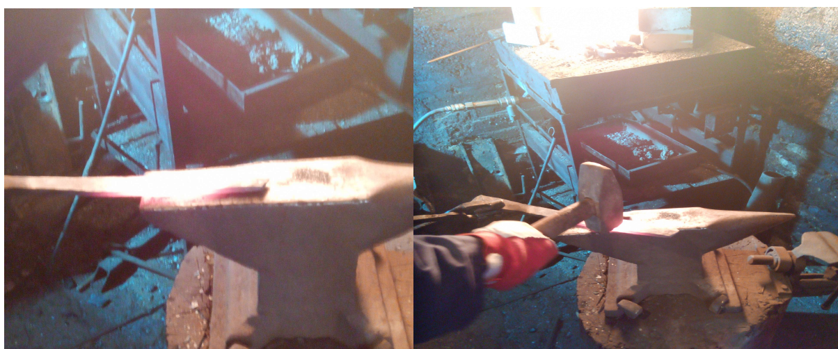
Slika 55 Ugrijavanje šipkastog materijala na kovačkoj vatri
