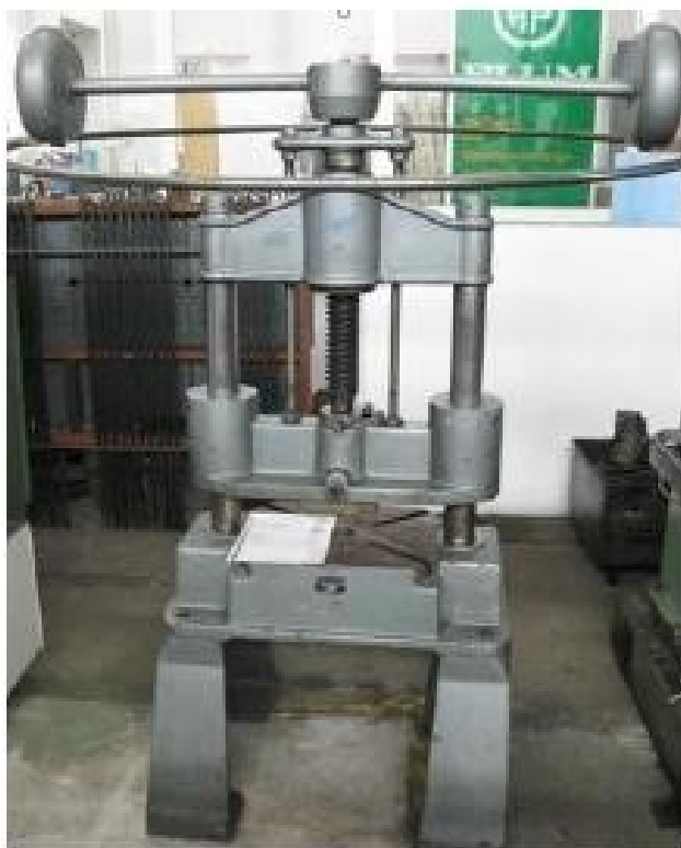
Slika 31 Vretenasta ručna preša [7]
