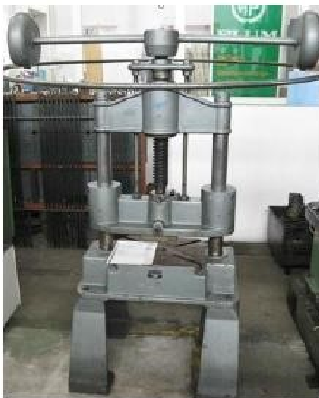
Slika 31 Vretenasta ručna preša [7]
