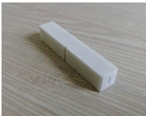
Slika 17. Epruveta za ispitivanje udarnog rada loma.
