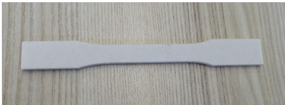
Slika 18. Epruveta za statički vlačni pokus.
