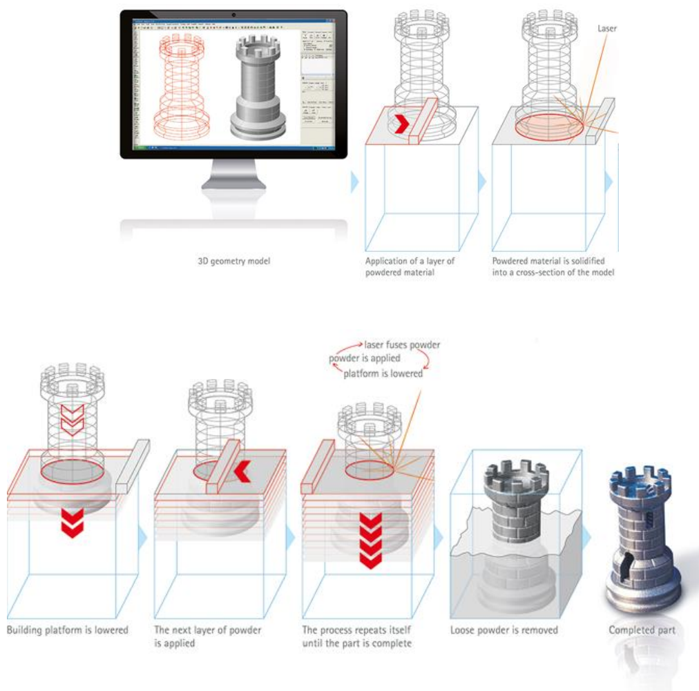
Slika 9. SLS postupak. [6]
