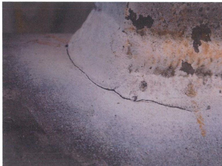
Slika 31: Magnetska indikacija – crno-bijela tehnika [3]
