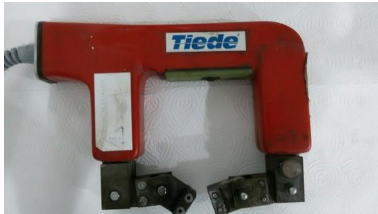
Slika 59: Magnetski jaram TIEDE TWM 230 A [6]
