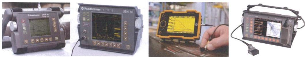
Slika 38: Digitalni ultrazvučni uređaji
