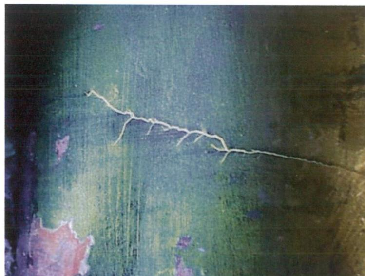
*Slika 12: Ispitivanje flurescentnim penetrantom [2]*
