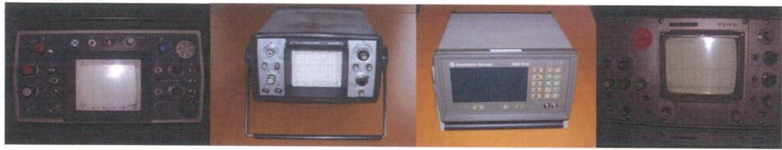
Slika 37: Analogni ultrazvučni uređaji
