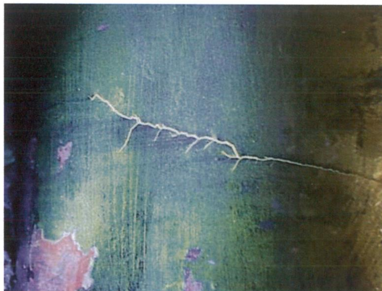
Slika 12: Ispitivanje flurescentnim penetrantom [2]
