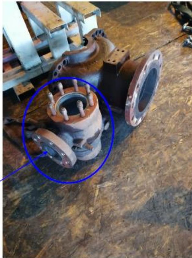
Kućište BZV-a, ulazni dio
