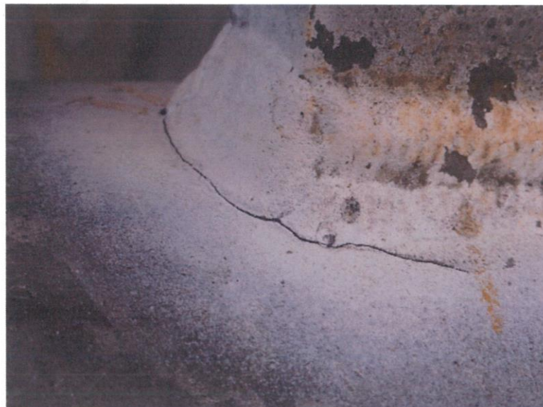
Slika 31: Magnetska indikacija – crno-bijela tehnika [3
