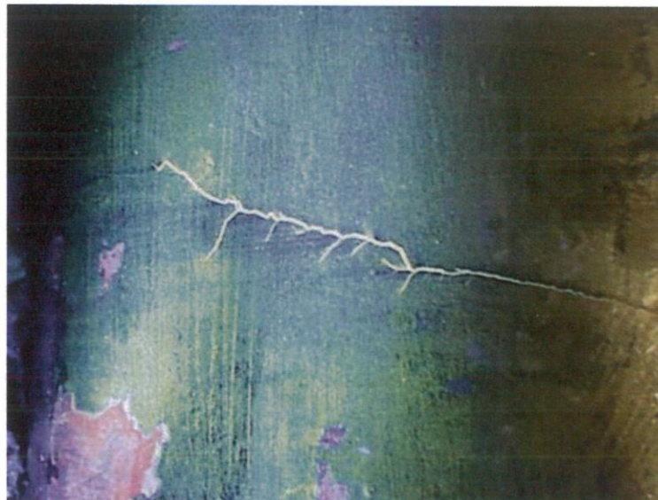
Slika 12: Ispitivanje flurescentnim penetrantom [2]
