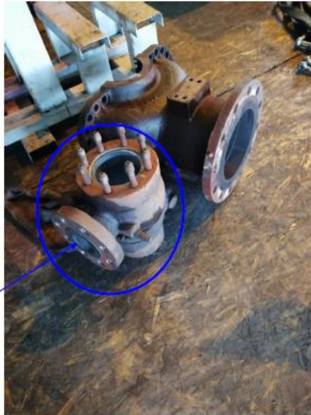
Kučište BZV-a, ulazni dio
