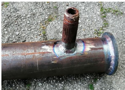
Slika 43. Zavareni spoj za manometarski ventil
