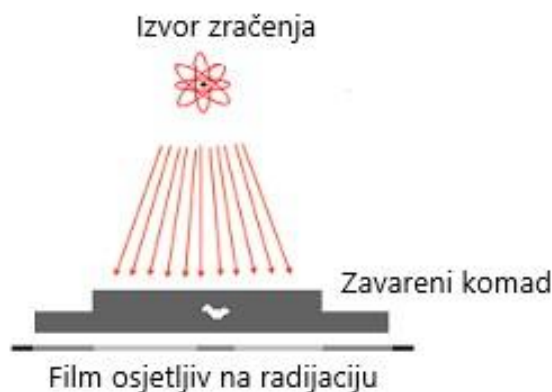
Slika 35. Shema radiografske metode [29]
