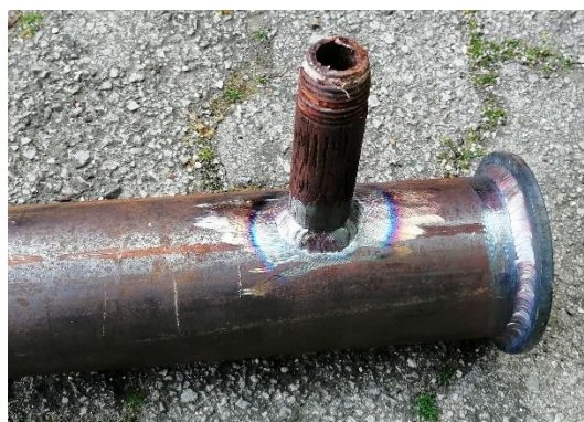
Slika 43. Zavareni spoj za manometarski ventil
