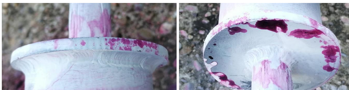
Slika 47. Izgleda zavara nakon nanošenja razvijlača
