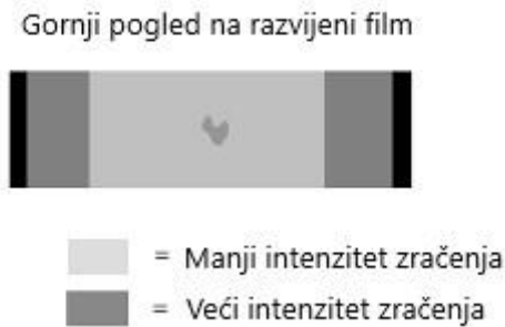
Slika 36. Shema prikaza većeg i manjeg intenziteta na filmu [29]
