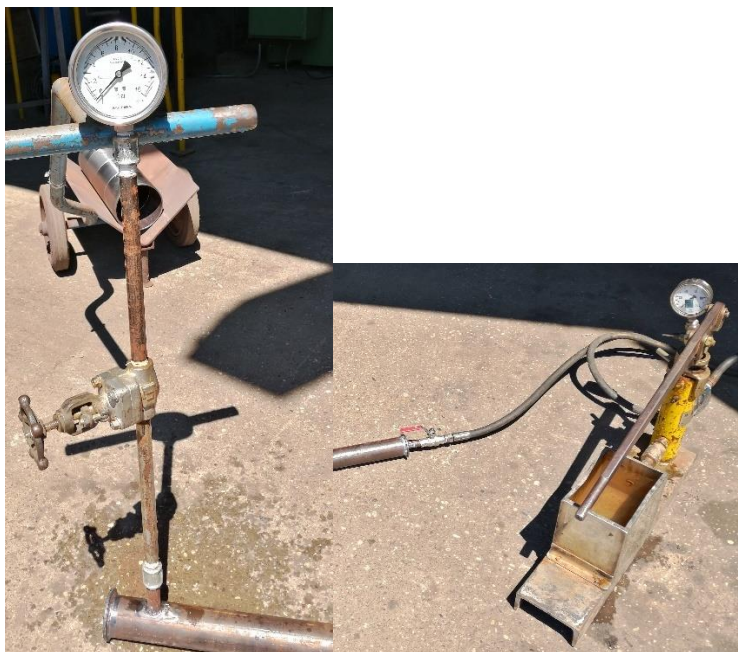
Slika 48. Spojeni manometar i pumpa za vodu na cijevnom sklopu
