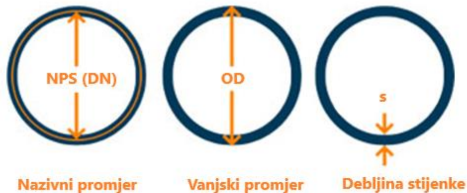
Slika 7. Oznake dimenzija cijevi [8]
