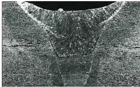
Slika 32. Pogreške naljepljivanja među slojevima [24]
