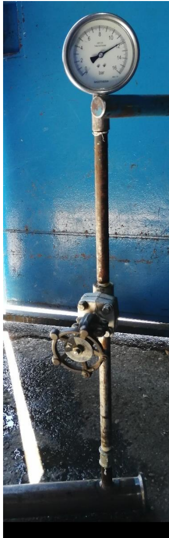
Slika 49. Postignut ispitni tlak
