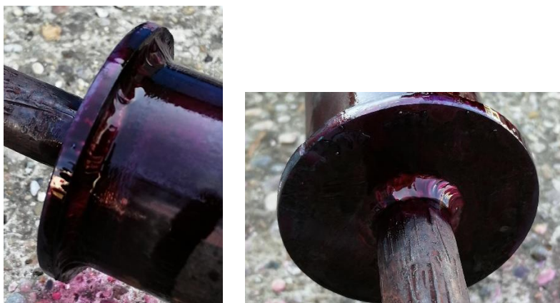
Slika 46. Faza penetriranja na zavarima
