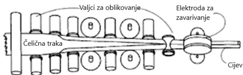
Slika 5. Način proizvodnje šavnih cijevi [6]
