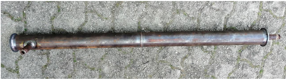
Slika 42. Zavareni cijevni sklop
