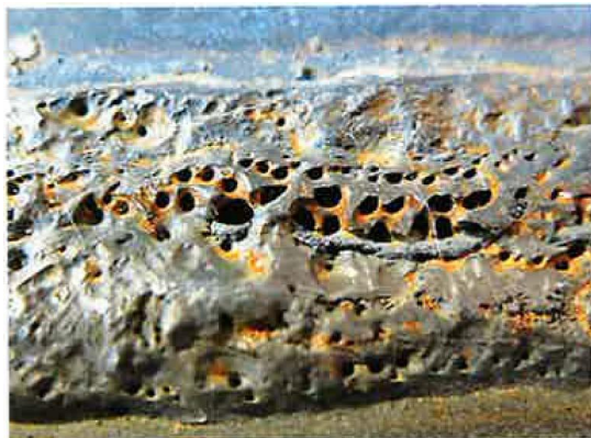
Slika 30. Površinska poroznost pri EPP zavarivanju čelika [24]
