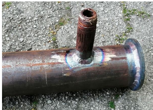
Slika 43. Zavareni spoj za manometarski ventil
