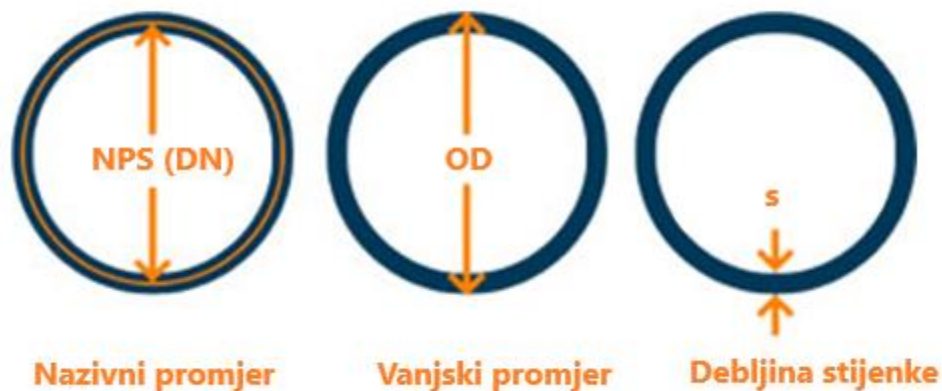
Slika 7. Oznake dimenzija cijevi [8]
