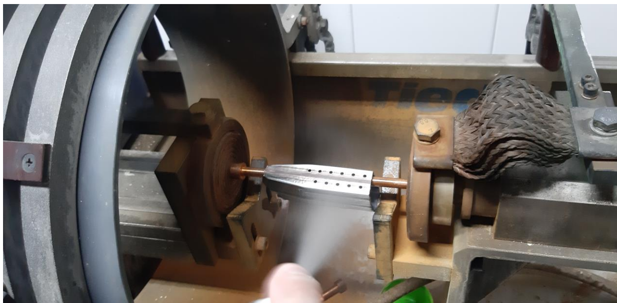
Slika 43. Nanošenje magnetskih čestica
