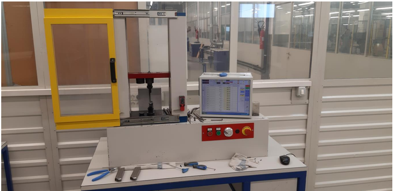
Slika 34. Stroj za dinamičko mjerenje sile
