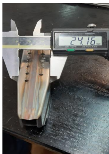
Slika 33. Dimenzionalno mjerenje pomičnim mjerilom
