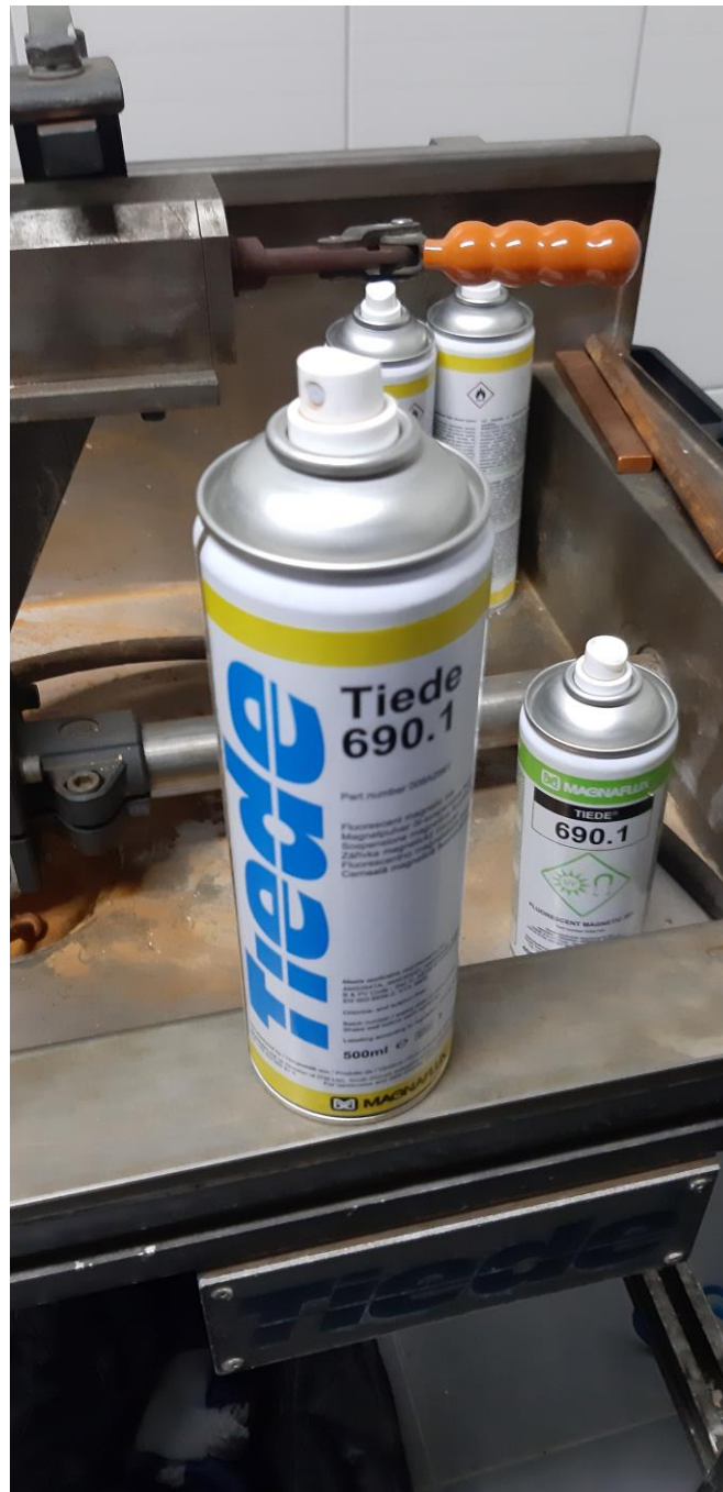
Slika 42. Magnetske čestice u spreju
