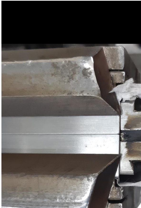
Slika 26. Stezna naprava za zavarivanje
