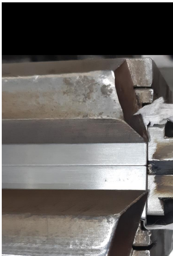
Slika 26. Stezna naprava za zavarivanje
