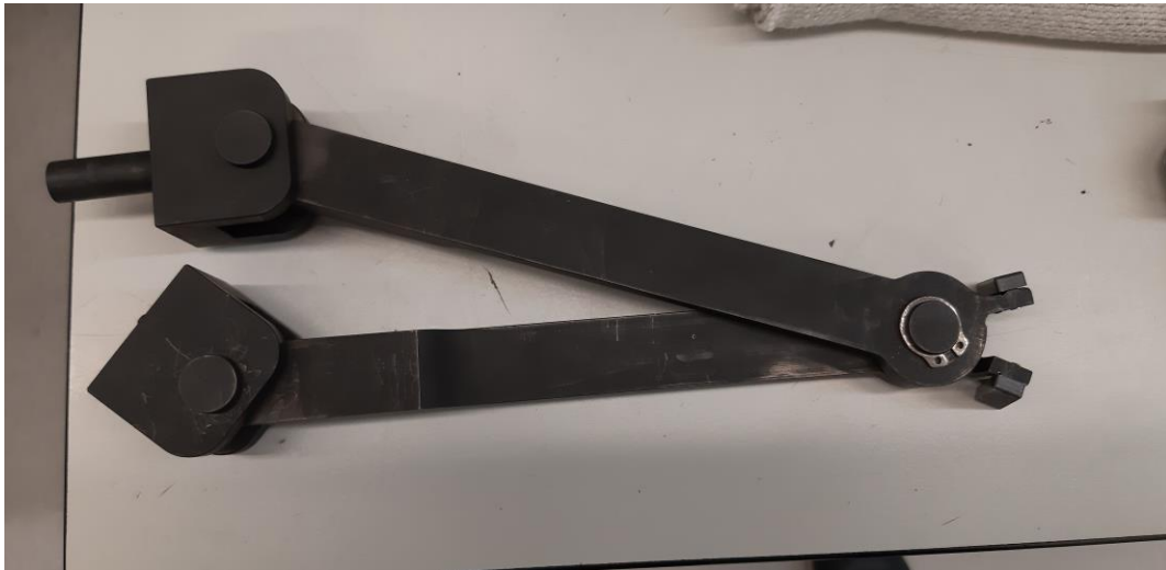
Slika 35. Priprema za stezanje kućišta
