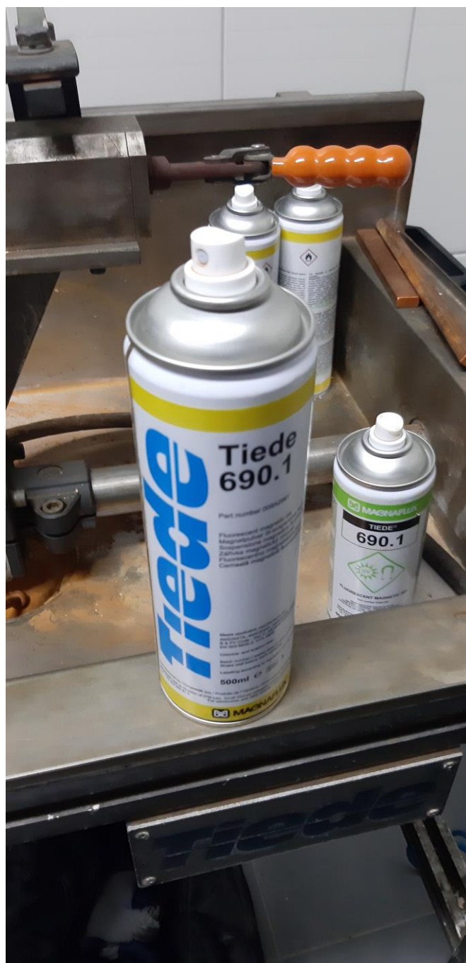
Slika 42. Magnetske čestice u spreju
