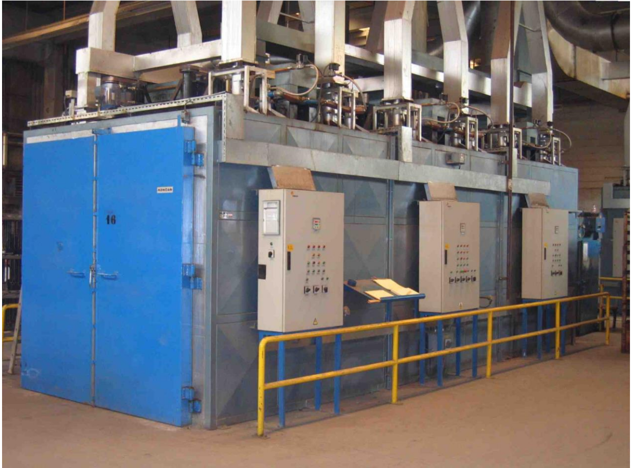
Slika 8. Automatska komorna peć za nitriranje
