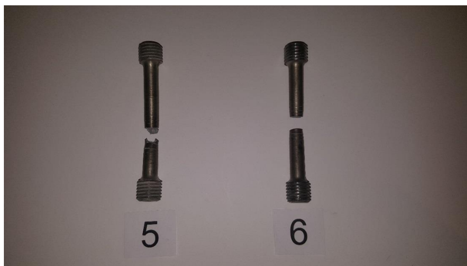
Slika 40. Vlačno ispitane ispitne epruvete od Č.4732
