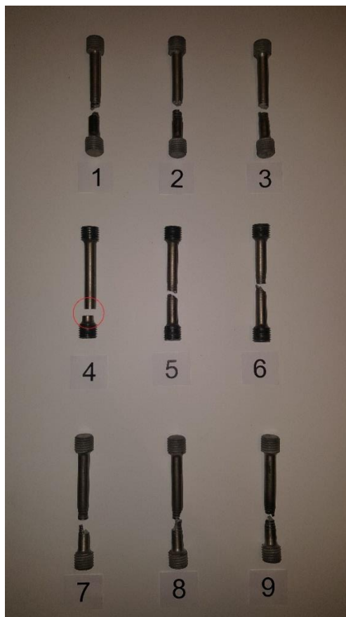
Slika 43. Ispitne epruvete od 1 do 9 nakon ispitivanja; epruveta 4 označena zbog netipičnog reza
