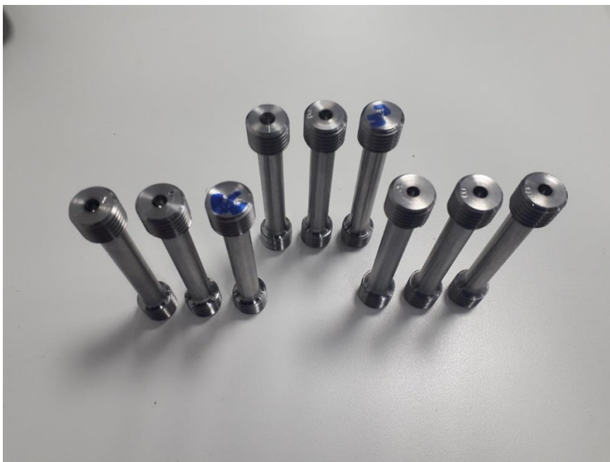
Slika 36. Priprema epruveta za proces nitriranja (epruvete oznake 1 do 9 )
