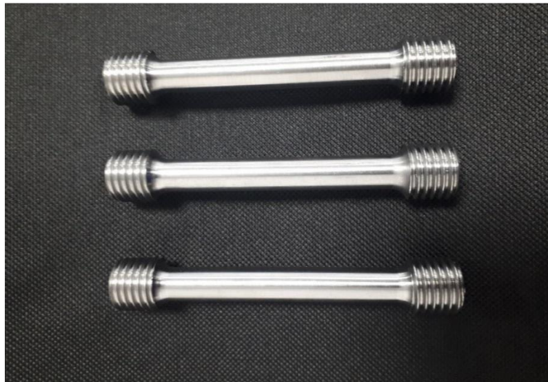
Slika 35. Priprema epruveta za proces nitriranja
