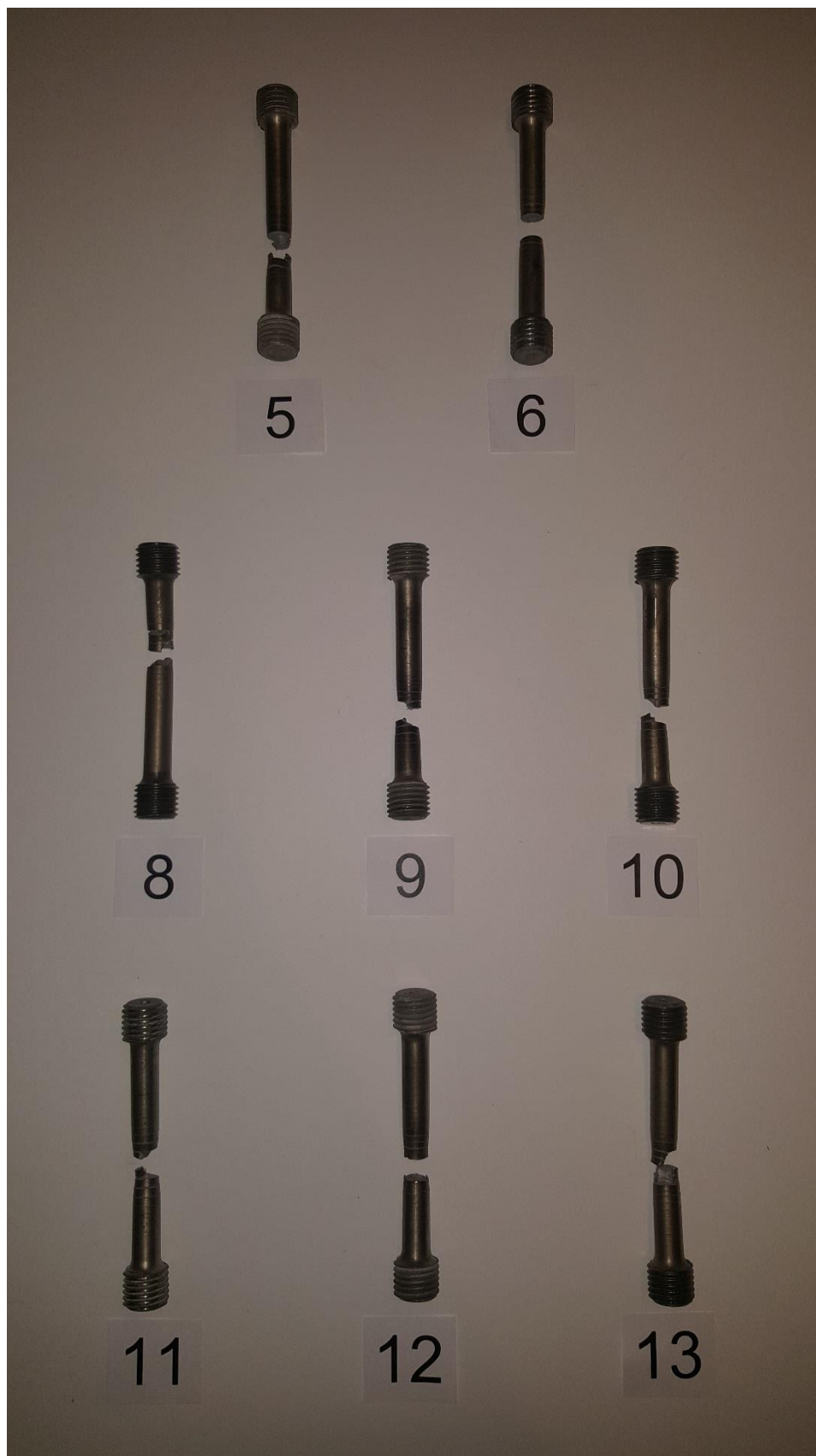
Slika 41. Epruvete od čelika Č.4732 nakon ispitivanja vlačne čvrstoće
