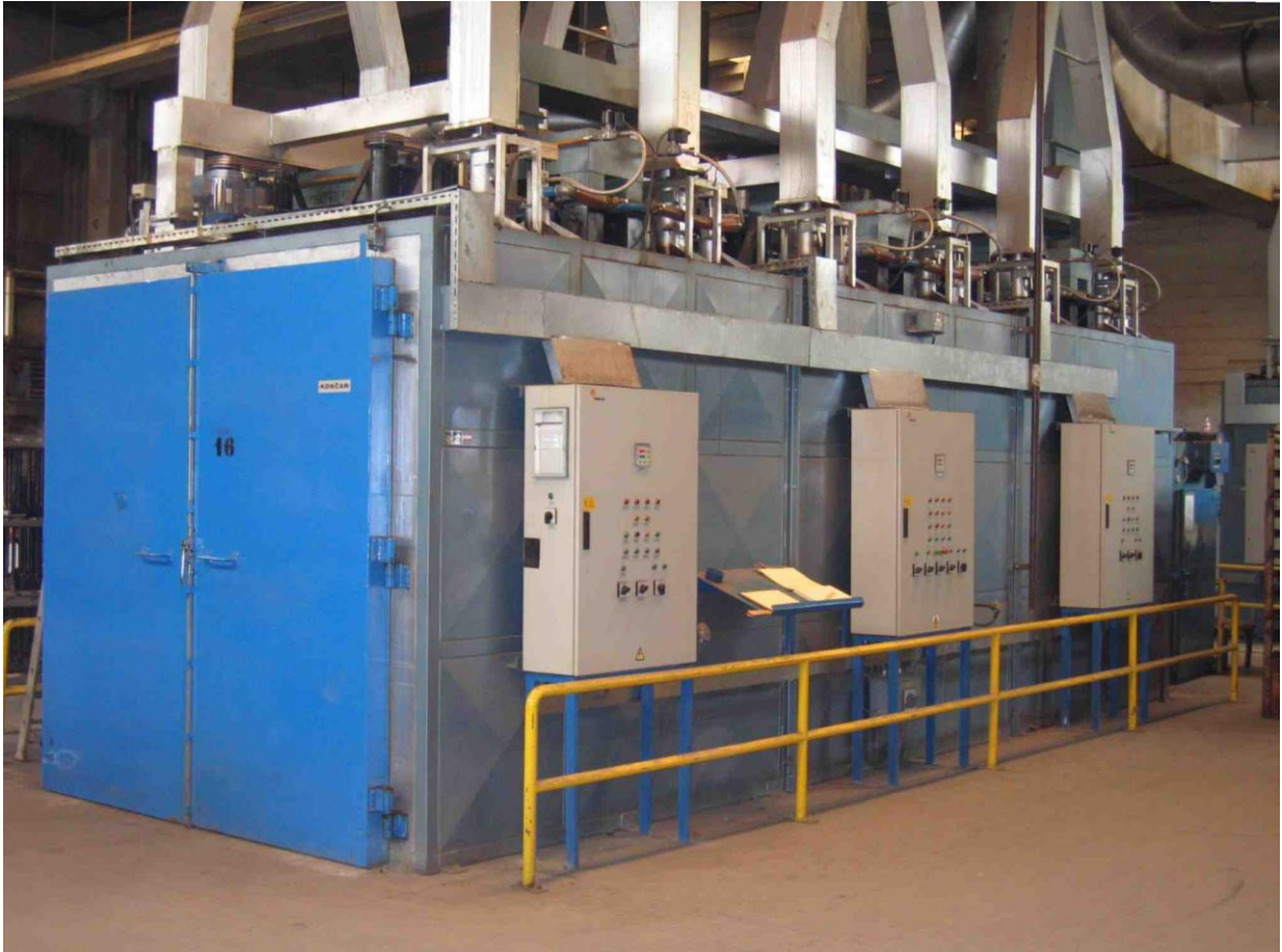
Slika 8. Automatska komorna peć za nitriranje
