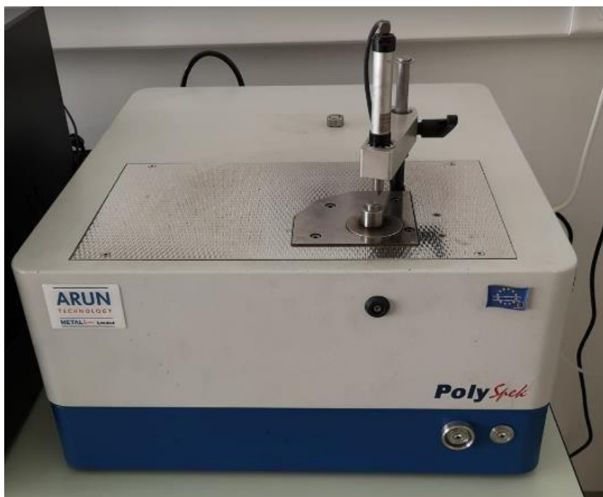
Slika 26. Uređaj za analizu kemijskog sastava materijala
