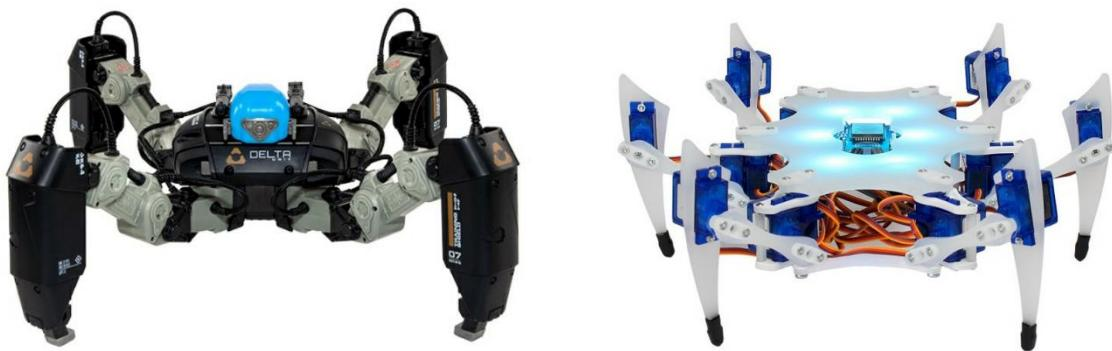
Slika 1: Quadruped (lijevo) [1], hexaped (desno) [2]
