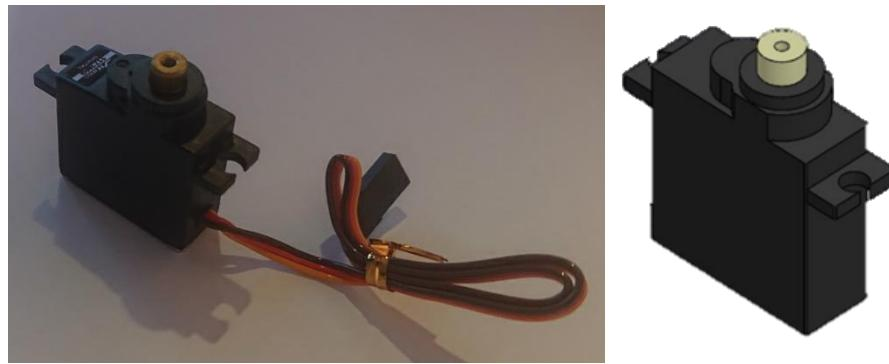
Slika 7: Servo motor 1171MG
