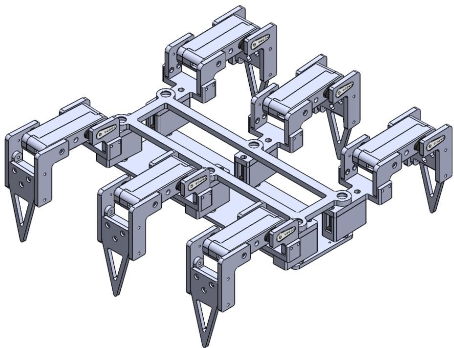
Slika 32: Prikaz sklopljenog modela robota
