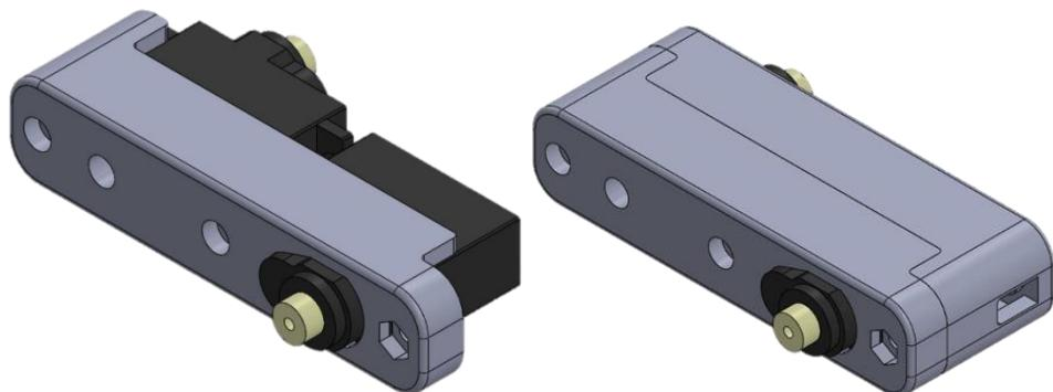
Slika 25: Postavljanje drugog servo motora u kućište
