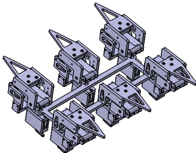
Slika 41: Robot u sklopljenom (fold) položaju
