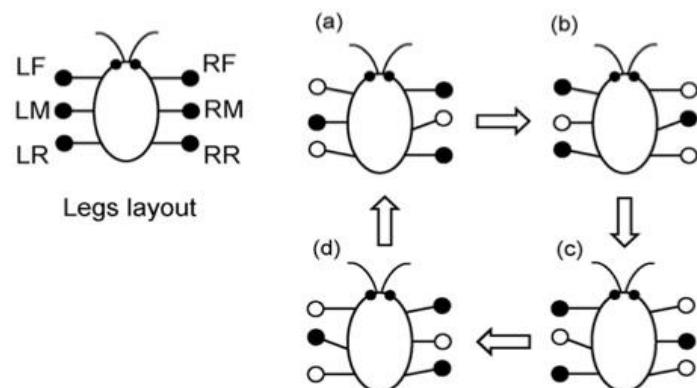
Slika 3: Ilustracija hoda šesteronožnog robota [4]
