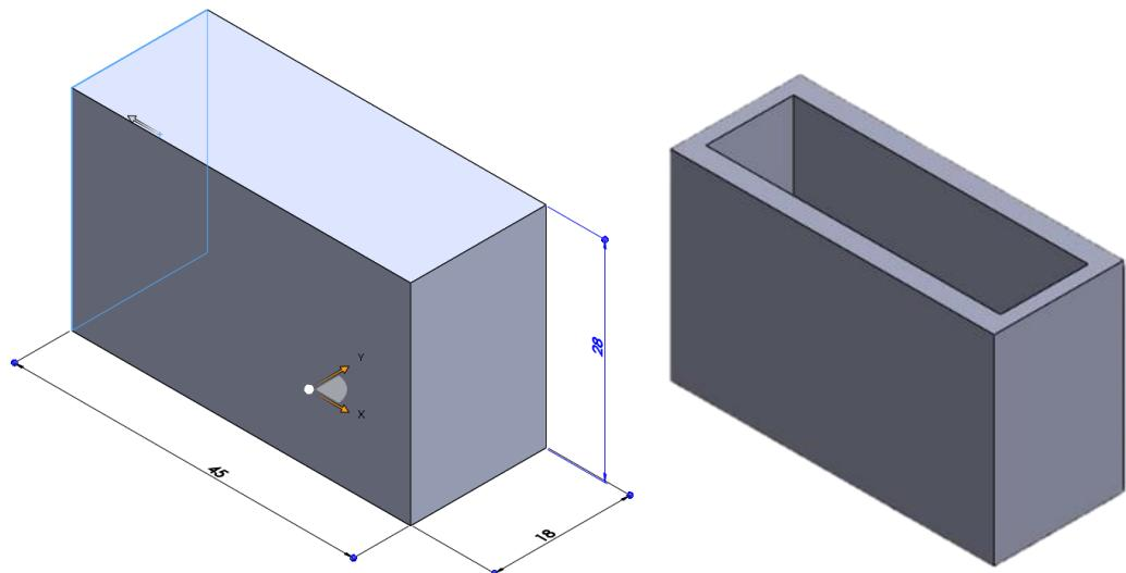
Slika 8: Boss-Extrude1 (lijevo) Cut-Extrude1 (desno)
