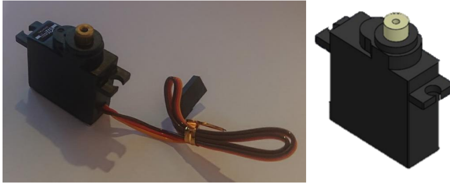
Slika 7: Servo motor 1171MG
