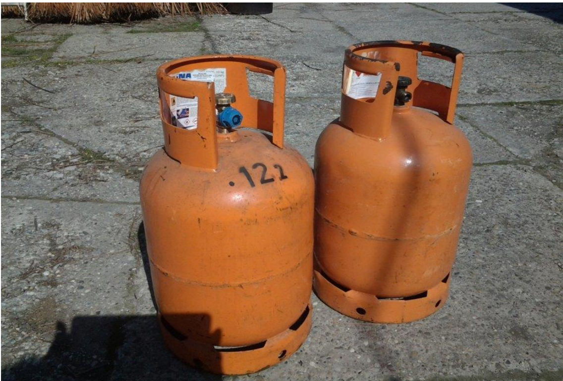
Slika 7. Plinske boce zapremnine 10 kg [6]
