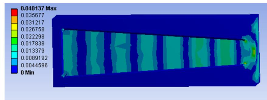
Slika 25. Brzina zvuka - 50% manji promjer na izlazu.[15]
