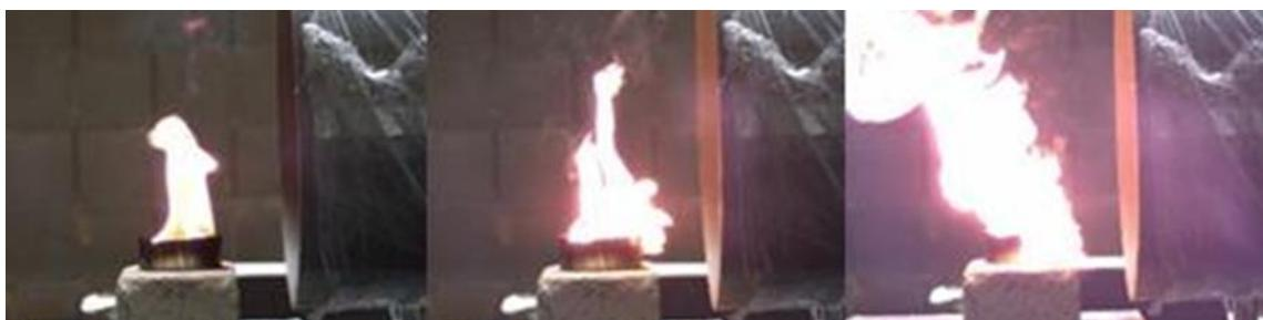
Slika 29. Gašenje zapaljivih tekućina zvukom.[15]
