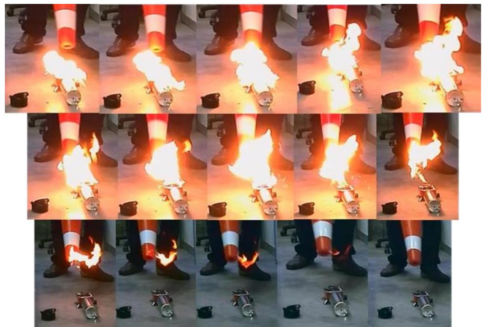
Slika 31. Vakuum efekt usmjerivača zvuka.[15]
