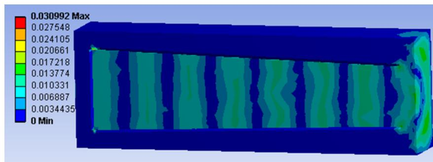
Slika 23. Brzina zvuka - 25% manji promjer na izlazu.[15]
