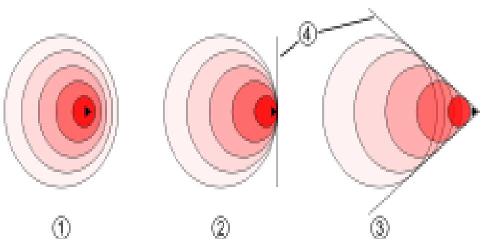
Slika 16. Probijanje zvučnog zida.[13]
