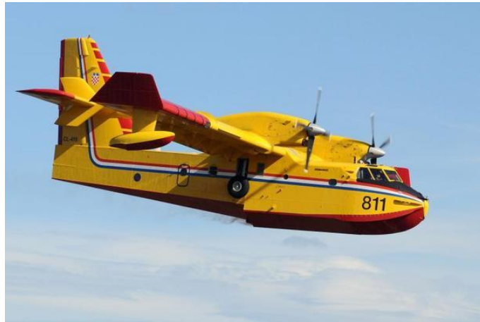
Slika 21. Protupožarni zrakoplov Canadair CL 415.[16]
