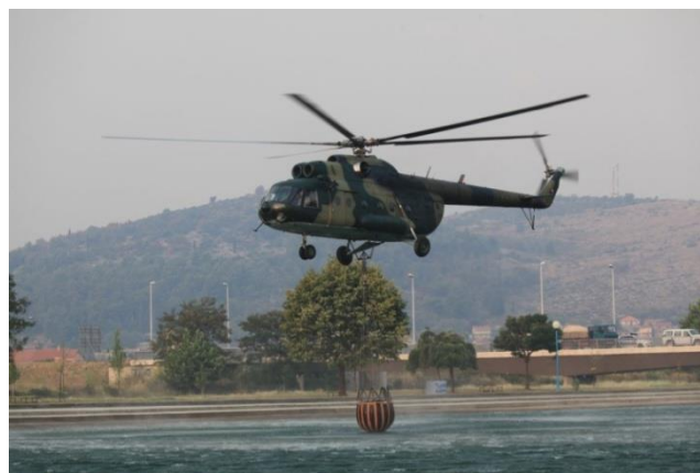
Slika 24. Helikopter Mi 8 MTV-1 opremljen elastičnim vjedrom [20]
