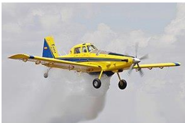
Slika 22. Protupožarni zrakoplov AirTractor AT 802 F [18]
