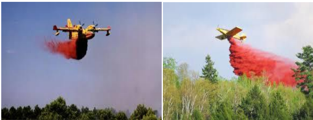
Slika 15. Nabacivanje retardanta uz pomoć protupožarnih zrakoplova [14]
