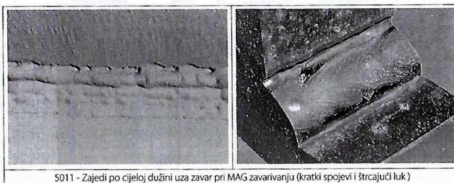
Slika 20. Pogreške oblika zavara-zajedi
