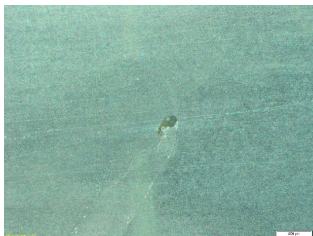
Slika 36. Plinski mjehurić-pora kuglastog oblika
