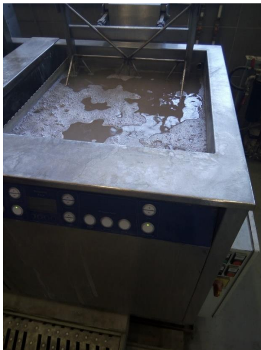
Slika 30. Ultrazvučno pranje uzoraka zavara u deterđentu
