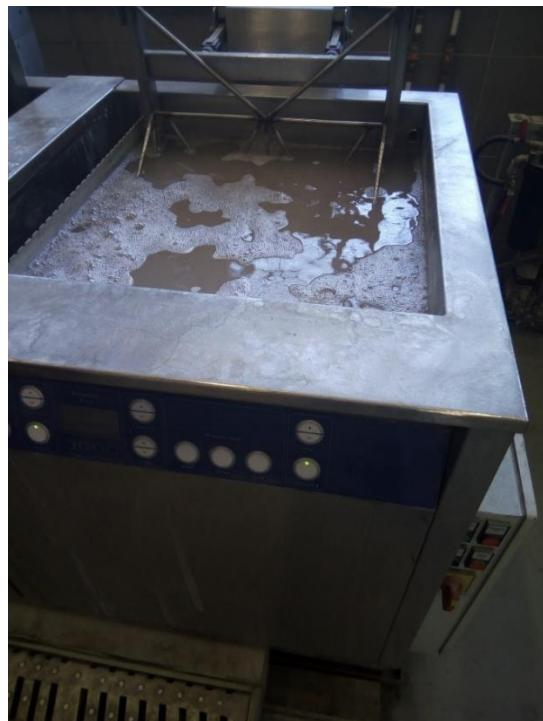
Slika 30. Ultrazvučno pranje uzorka zavara u deterđentu
