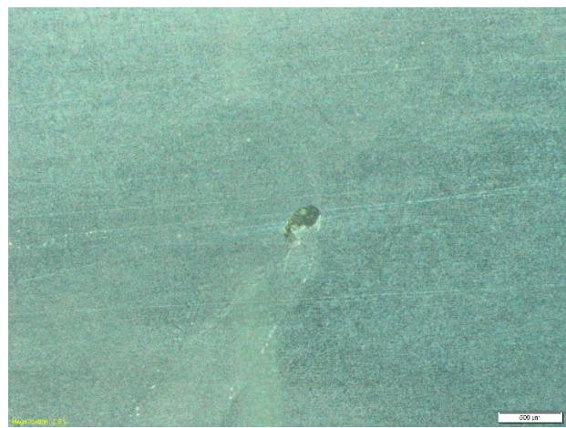
Slika 36. Plinski mjehurić-pora kuglastog oblika
