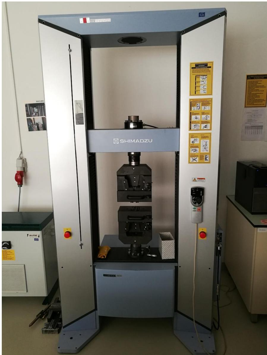
Slika 19. Kidalica SHIMADZU AG-X
