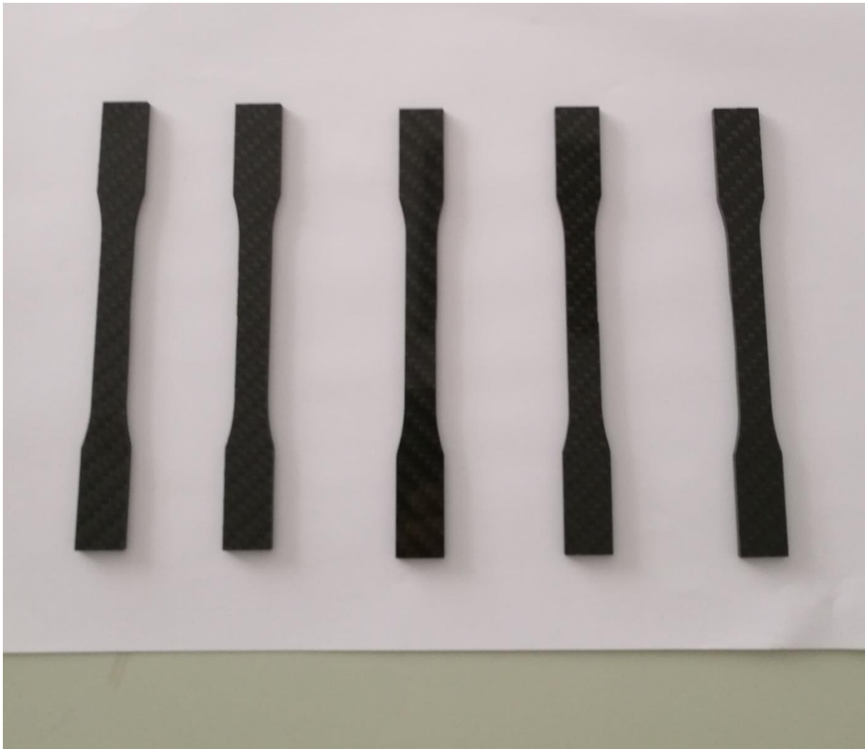
Slika 21. Epruvete pripravljene za ispitivanje vlačne čvrstoće
