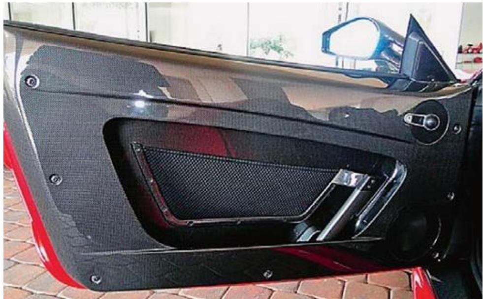
*Slika 16. Paneli vrata načinjeni od plastomerne matrice ojačane ugljikovim vlaknima*
