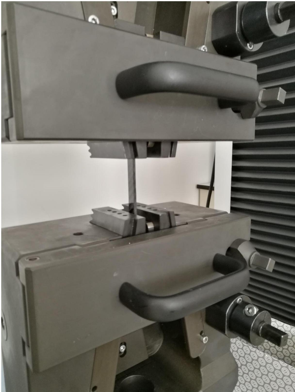
*Slika 22. Epruveta postavljena u kidalicu*
